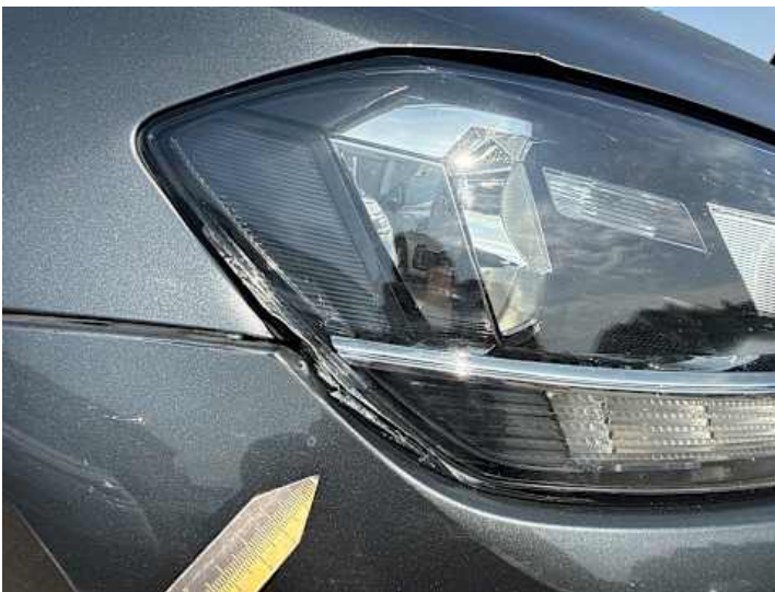
Scheinwerfer (rechts) (Riss/Bruch)
