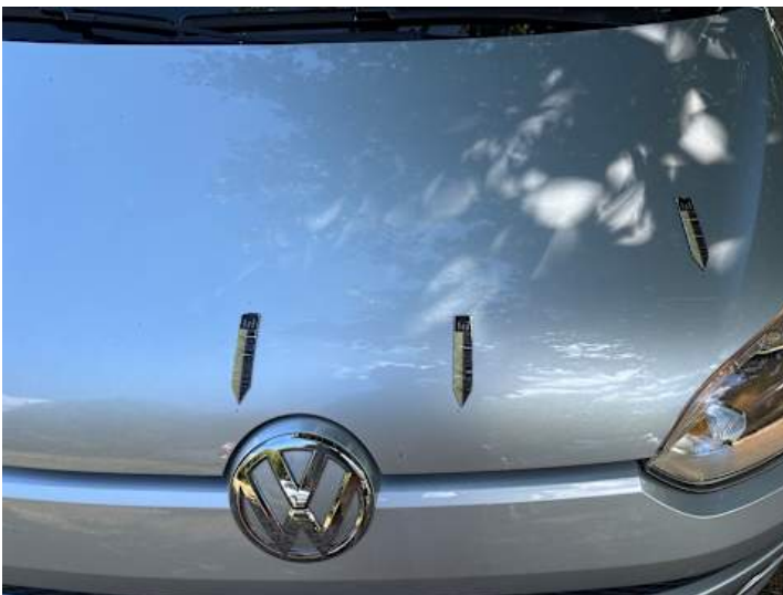
Motorhaube (Steinschlag, Rost)
