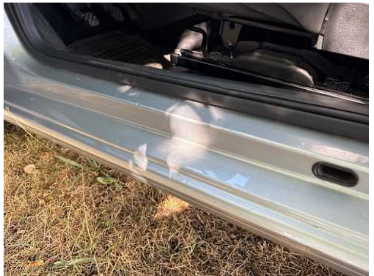
Schweller links (Kratzer, Delle)
