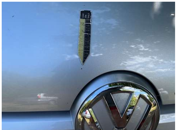
Motorhaube (Steinschlag, Rost)
