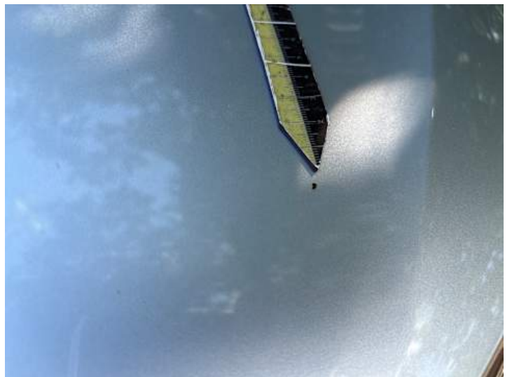
Motorhaube (Steinschlag, Rost)
