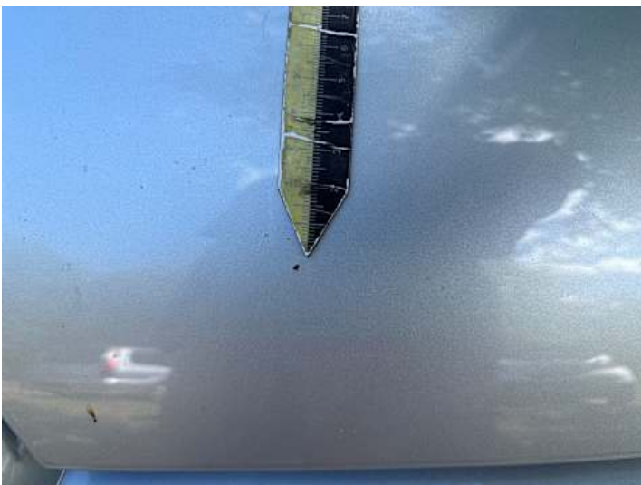
Motorhaube (Steinschlag, Rost)
