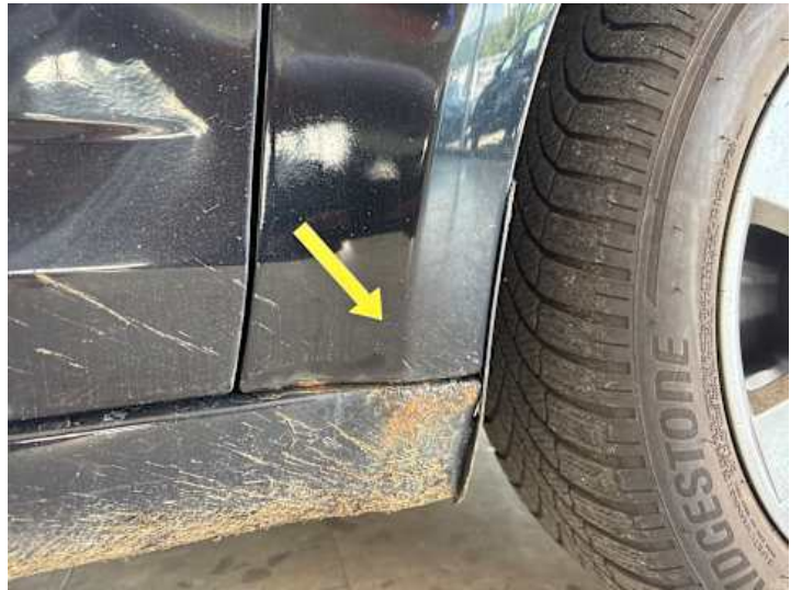
Kotflügel vorne rechts (Unsachgemäß instand gesetzt, Rost)
