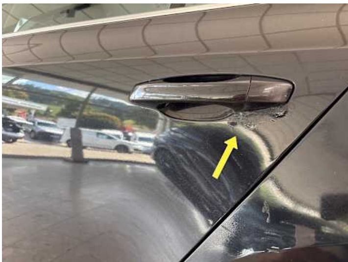
Türe hinten links (Rost)
