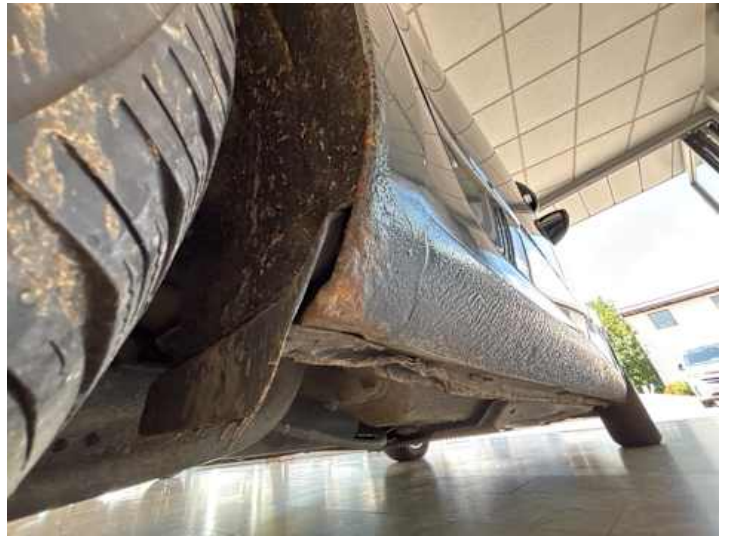
Schweller rechts (Rost, Verformung)
