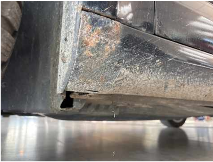
Schweller links (Rost)
