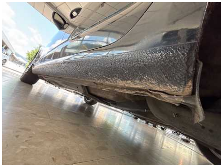
Schweller links (Rost)
