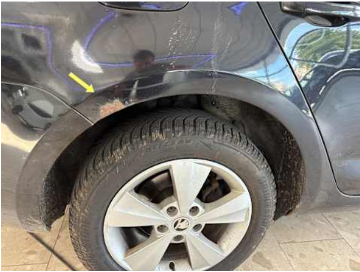
Seitenteil hinten rechts (Rost)
