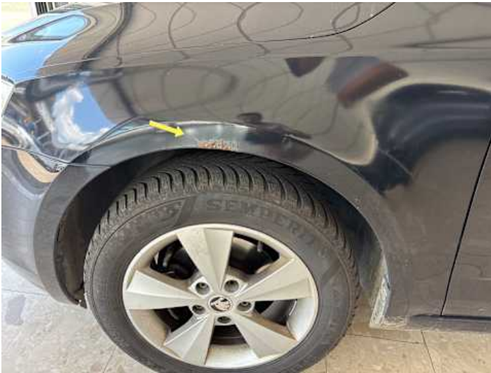
Kotflügel vorne links (Rost, Unsachgemäß instand gesetzt)
