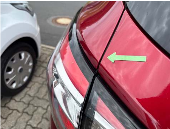
Heckklappe (Spaltmaße ungenau)
