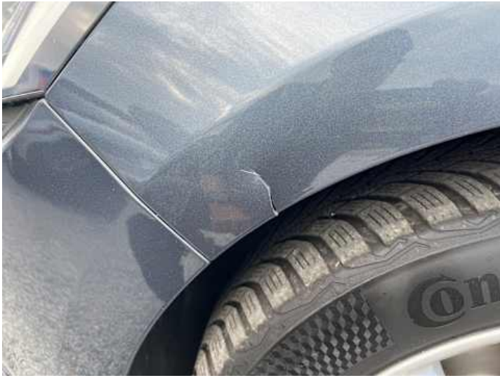
Kotflügel vorne links (Riss/Bruch)
