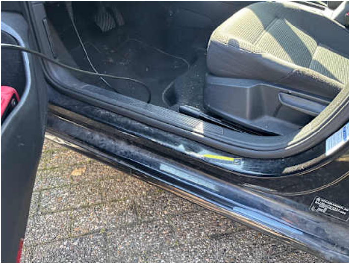
Schweller links (Lackschaden)
