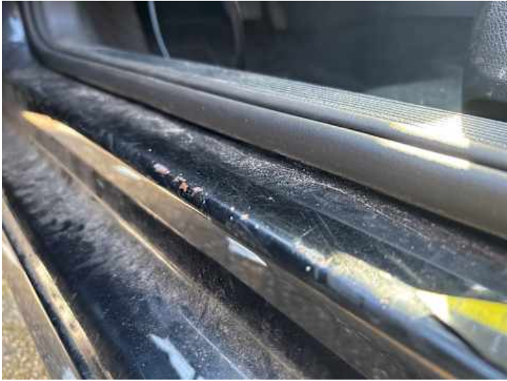
Schweller links (Lackschaden)
