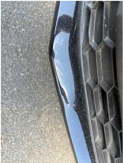
Schweller links (Verformung, Lackschaden)
