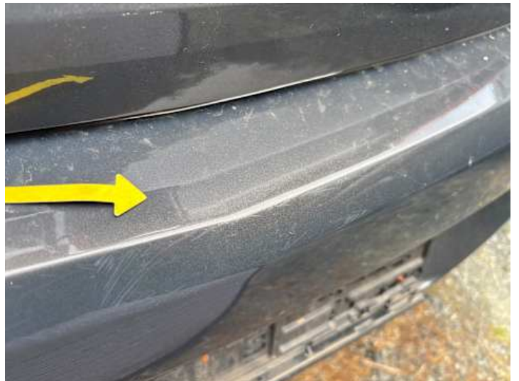
Stoßstange hinten (Kratzer)
