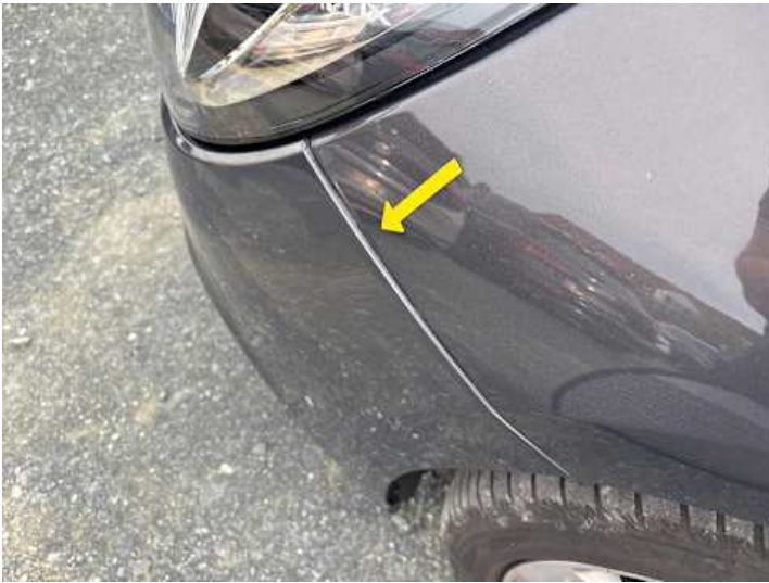
Stoßstange vorne (Spaltmaße ungenau, Unsachgemäß instand gesetzt)
