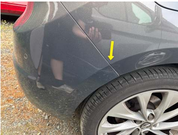
Stoßstange hinten (Spaltmaße ungenau, Unsachgemäß instand gesetzt)
