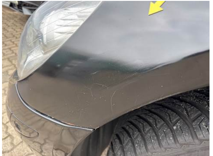
Kotflügel vorne links (Lackschaden, Unsachgemäß instand gesetzt, Rost)
