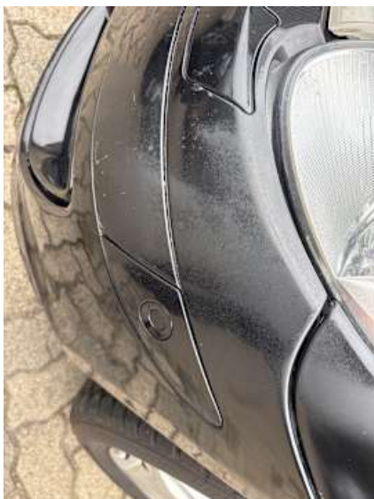
Stoßstange vorne (Lackschaden)
