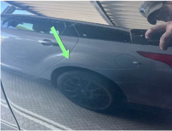
Türe hinten links (Lackschaden, Kratzer)
