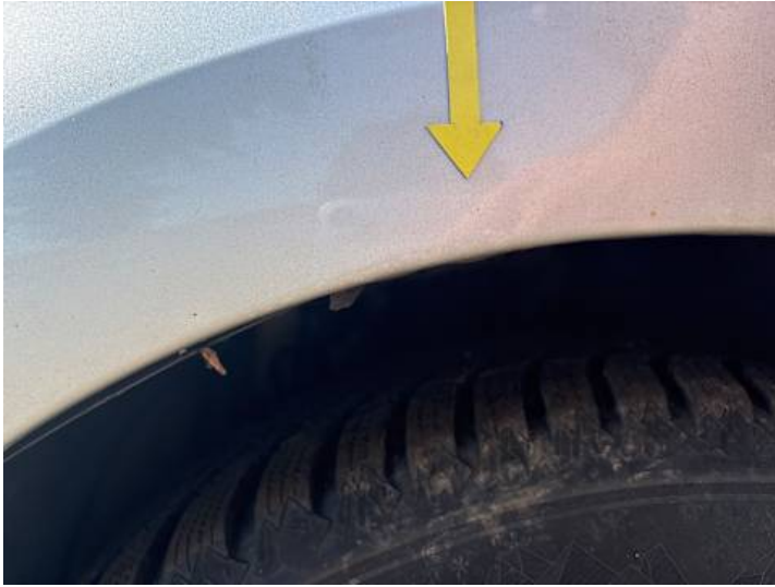
Kotflügel vorne rechts (Rost)
