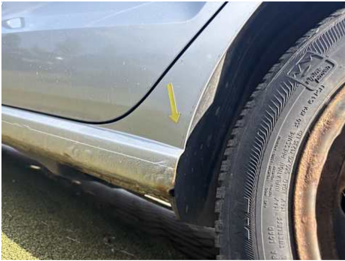
Schweller links (Rost)
