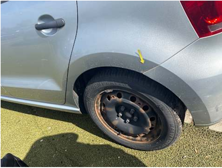
Seitenteil hinten links (Rost)
