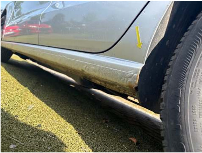
Schweller links (Rost)
