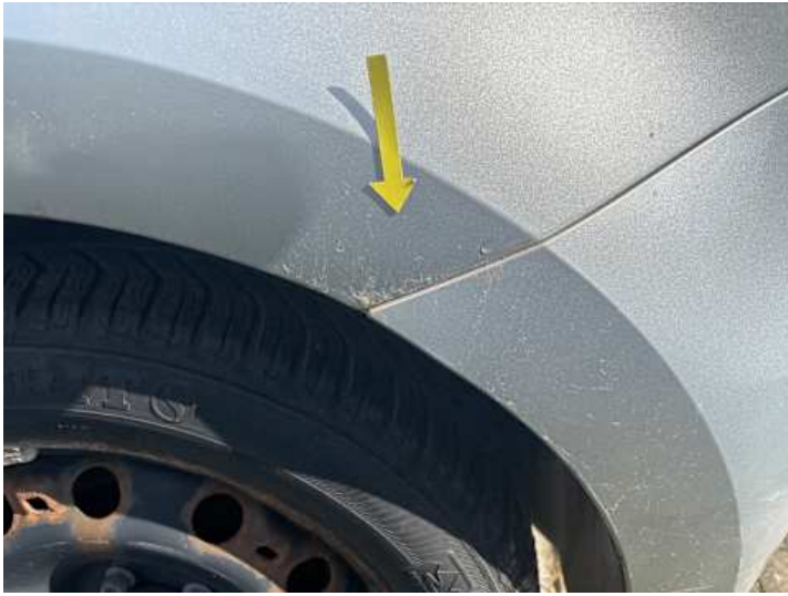
Seitenteil hinten links (Rost)
