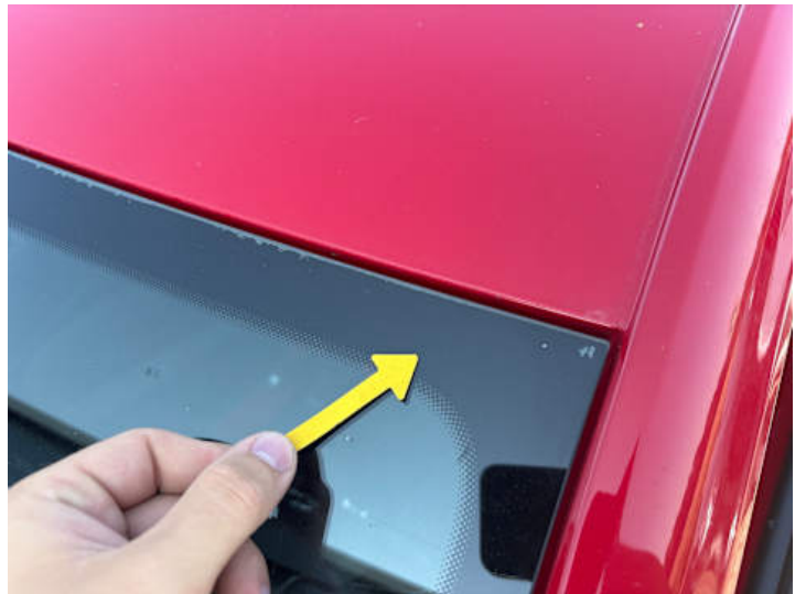
Windschutzscheibe (Anderer Schaden): Ablösung
