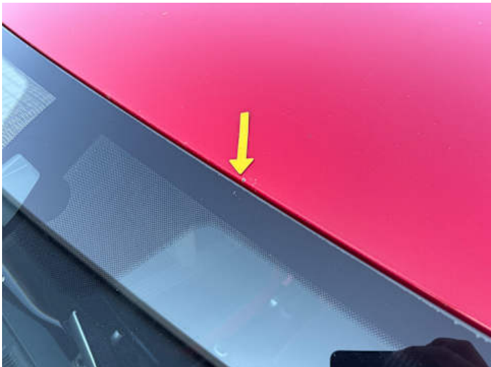
Dach (Lackschaden, Steinschlag)
