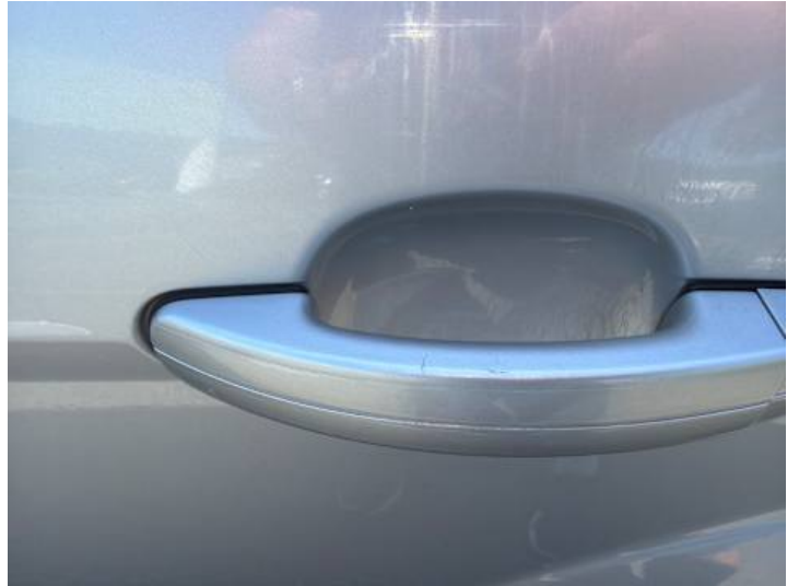
Türe hinten links (Kratzer)
