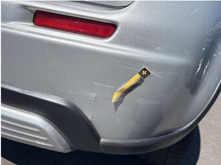
Stoßstange hinten (Riss/Bruch, Lackschaden)
