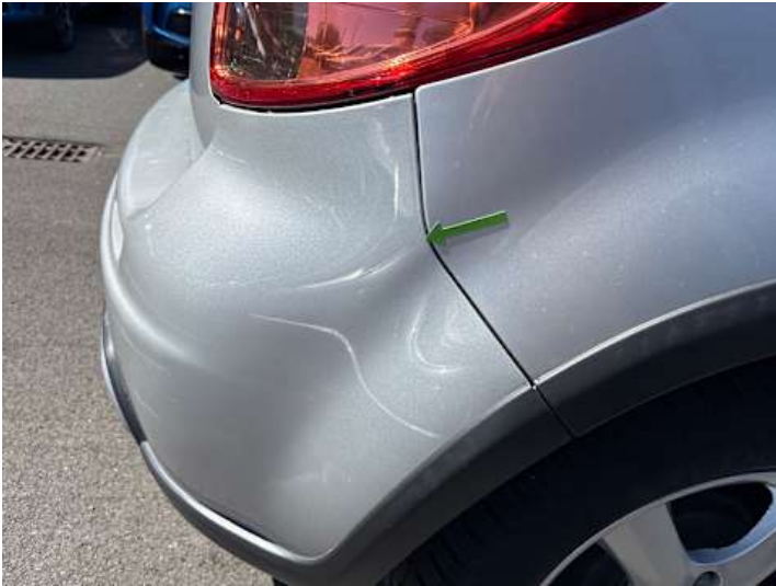
Stoßstange hinten (Unsachgemäß instand gesetzt)
