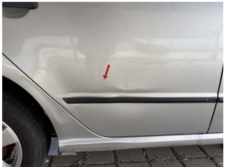
Türe hinten rechts (Verformung)
