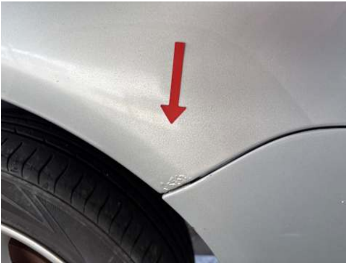
Seitenteil hinten links (Rost)
