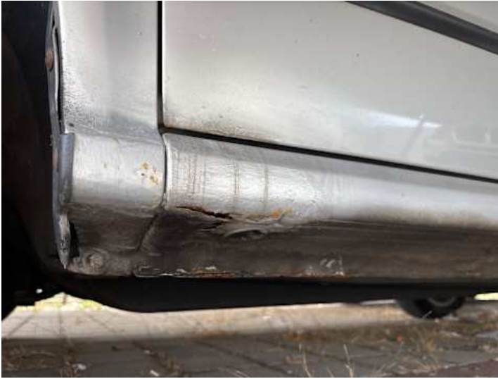
Schweller links (Rost)
