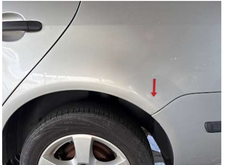
Seitenteil hinten links (Rost)
