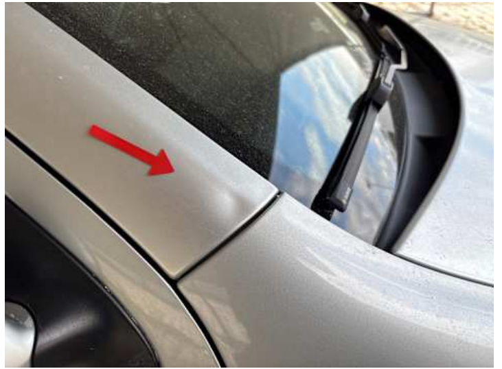
Kotflügel vorne rechts (Delle)
