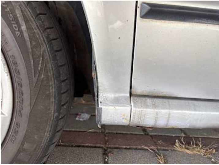
Kotflügel vorne links (Rost)
