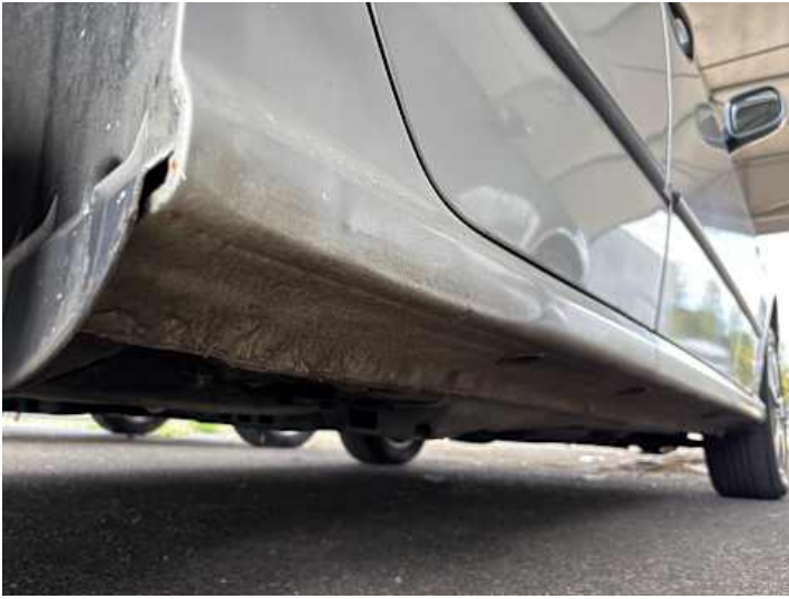
Schweller rechts (Verformung)
