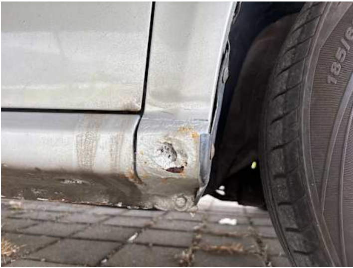
Kotflügel vorne rechts (Rost)
