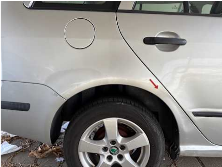
Seitenteil hinten rechts (Ausgeblichen/Matt, Verformung, Unsachgemäß instand gesetzt)
