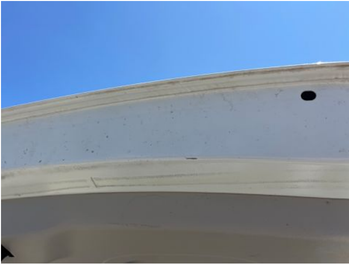
Heckklappe (Lackschaden, Kratzer)
