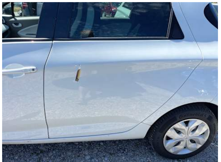
Türe hinten links (Kratzer, Lackschaden)
