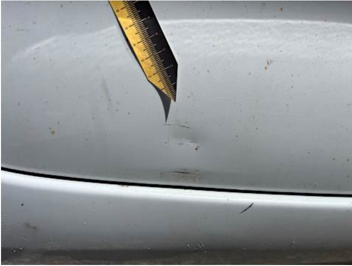
Türe hinten rechts (Lackschaden, Kratzer, Delle)
