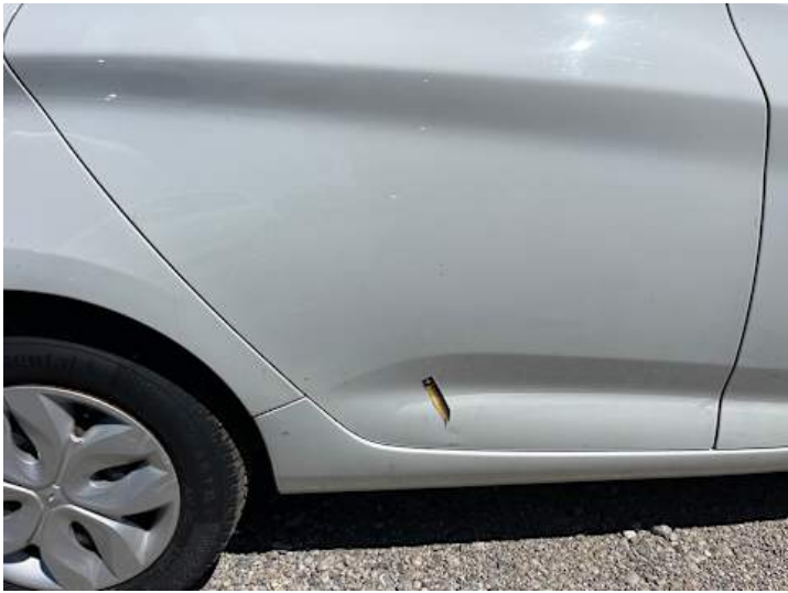
Türe hinten rechts (Lackschaden, Kratzer, Delle)
