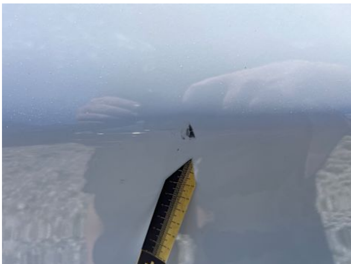
Türe hinten links (Kratzer, Lackschaden)
