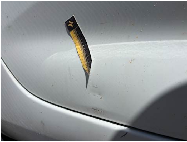
Türe hinten rechts (Lackschaden, Kratzer, Delle)
