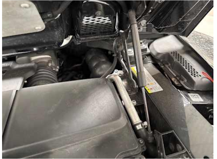
Innenraum (Anderer Schaden): Dämpfer beschädigt ohne Funktion.
