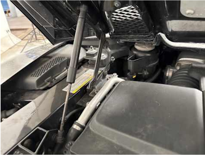
Innenraum (Anderer Schaden): Dämpfer beschädigt ohne Funktion.
