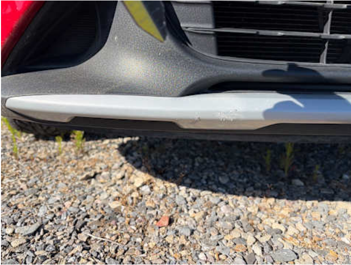
Stoßstange vorne (Lackschaden, Kratzer)
