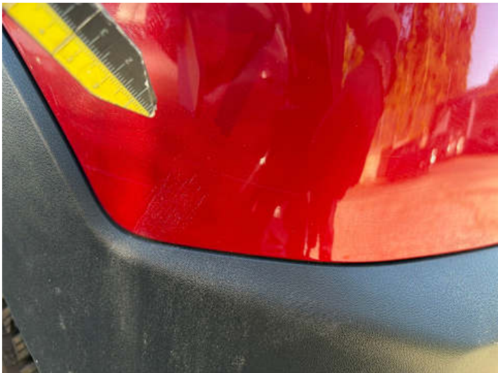
Stoßstange hinten (Lackschaden, Kratzer)
