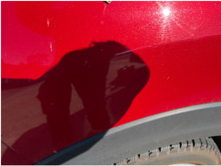
Seitenteil hinten rechts (Lackschaden, Kratzer)
