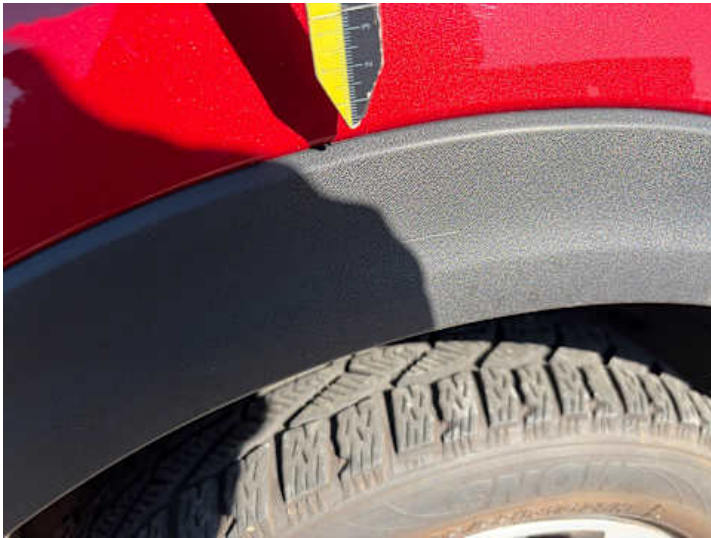
Kotflügel vorne rechts (Lackschaden, Kratzer)
