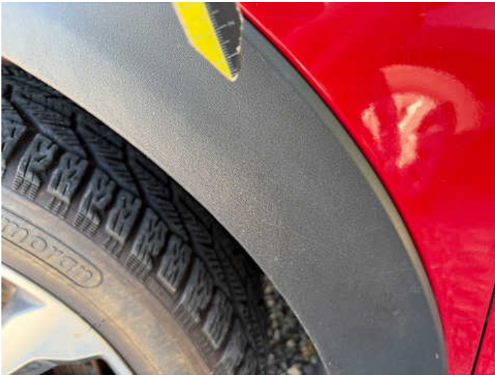
Kotflügel vorne links (Lackschaden, Kratzer)
