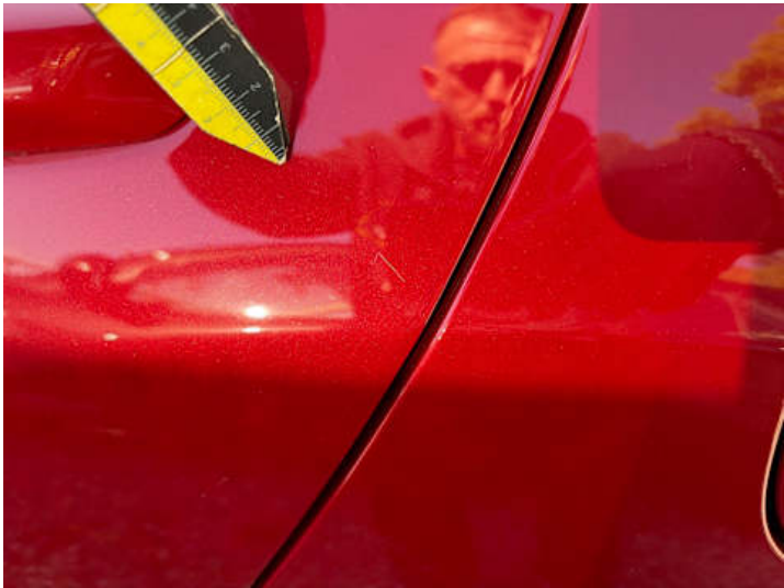
Türe hinten links (Lackschaden, Kratzer)
