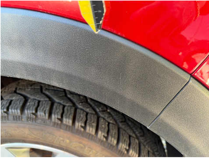
Seitenteil hinten links (Lackschaden, Kratzer)
