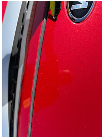
Motorhaube (Lackschaden, Kratzer, Steinschlag)
