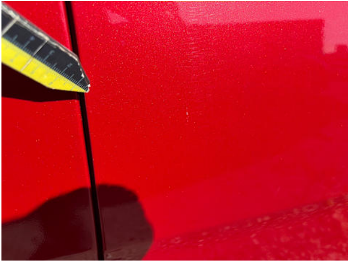
Beifahrtür (Lackschaden, Kratzer)
