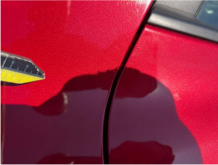
Seitenteil hinten rechts (Lackschaden, Kratzer)
