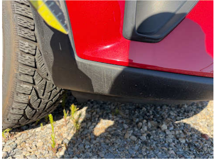
Stoßstange vorne (Lackschaden, Kratzer)
