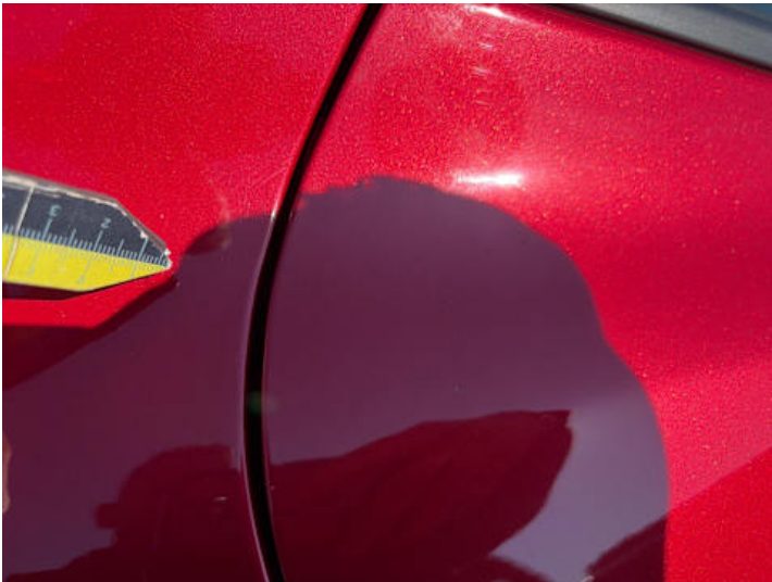
Türe hinten rechts (Lackschaden, Kratzer)
