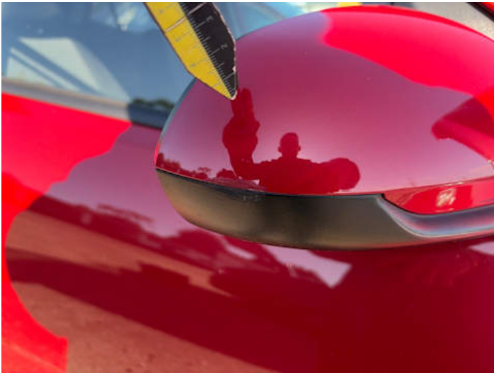
Beifahrertür (Lackschaden, Kratzer)
