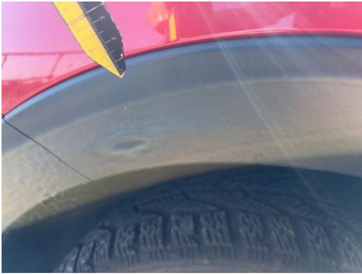
Kotflügel vorne links (Lackschaden, Kratzer)
