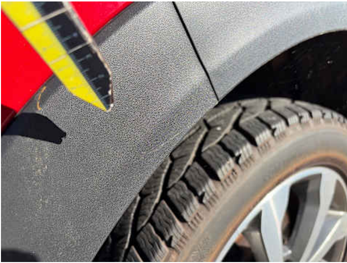
Stoßstange hinten (Lackschaden, Kratzer)
