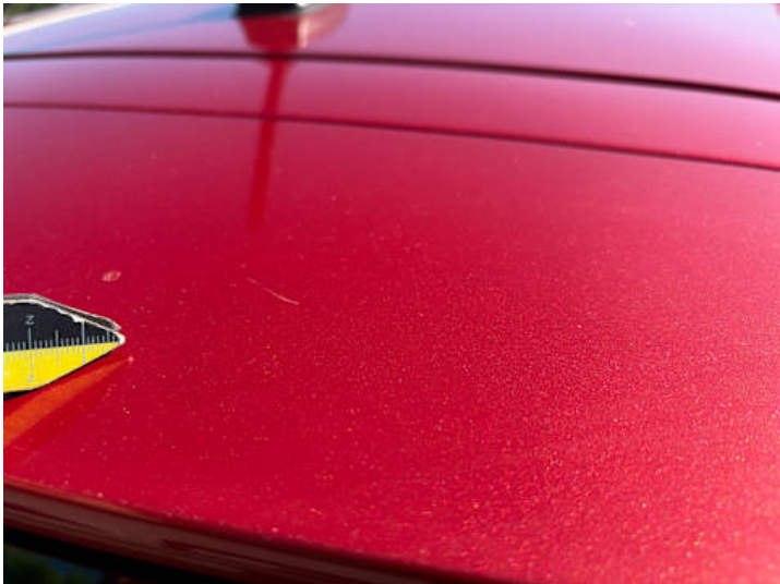
Dach (Lackschaden, Kratzer)
