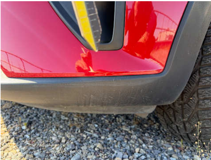
Stoßstange vorne (Lackschaden, Kratzer)
