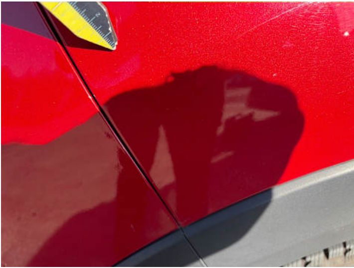
Seitenteil hinten rechts (Lackschaden, Kratzer)
