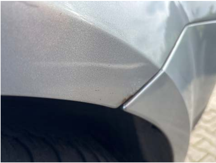
Seitenteil hinten links (Verformung, Rost)
