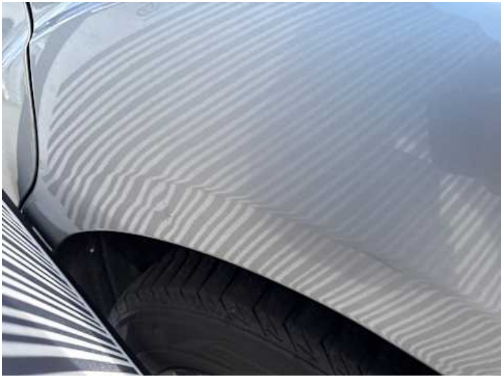
Seitenteil hinten links (Verformung, Rost)
