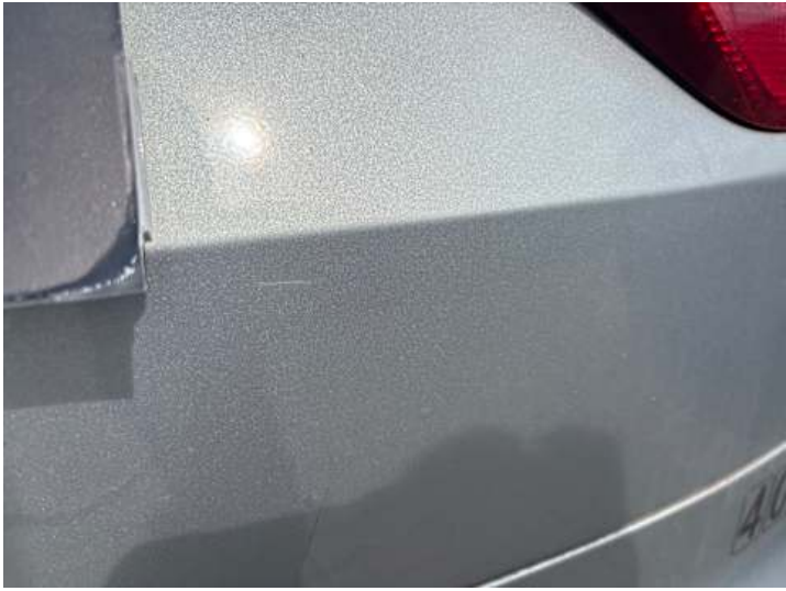
Heckklappe (Kratzer, Rost)
