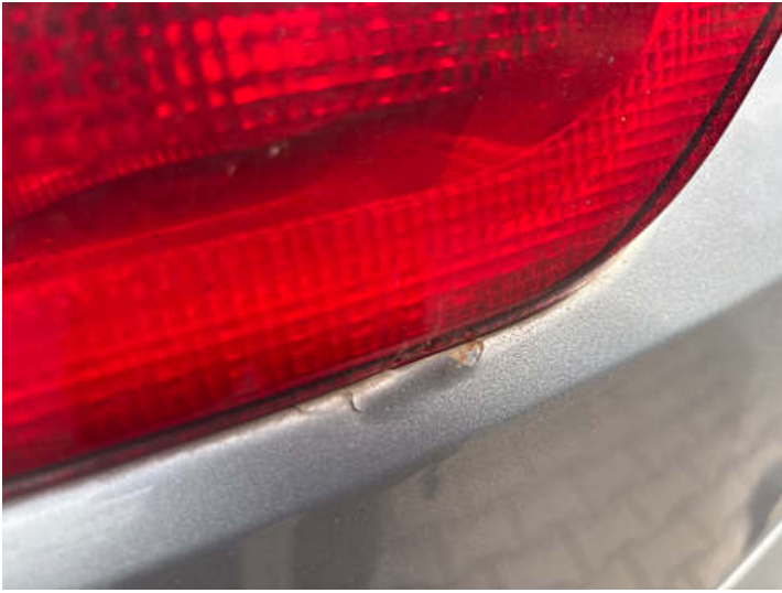
Heckklappe (Kratzer, Rost)
