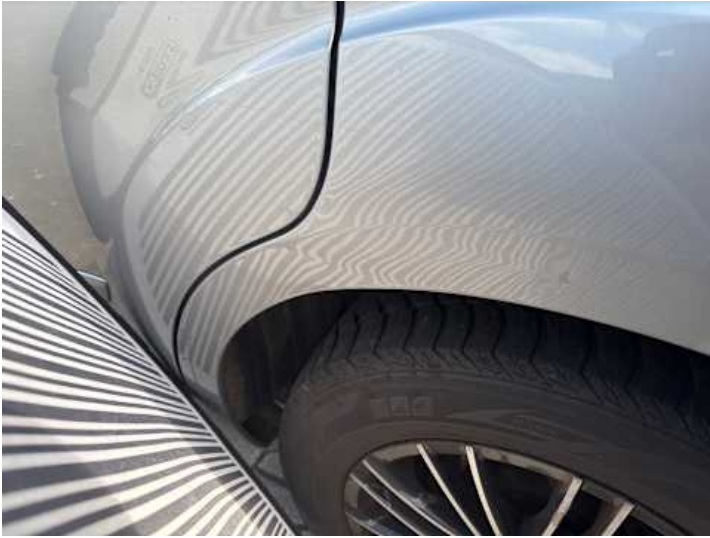
Seitenteil hinten links (Verformung, Rost)
