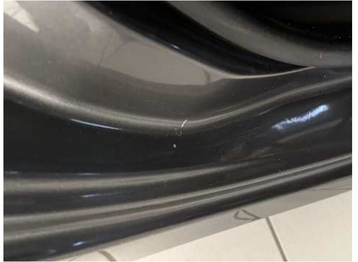
Türe hinten rechts (Kratzer, Lackschaden)
