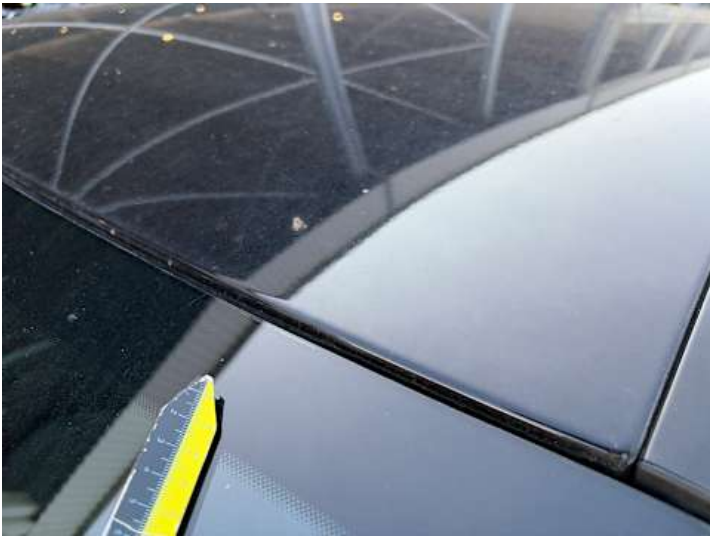
Dach (Lackschaden, Steinschlag)
