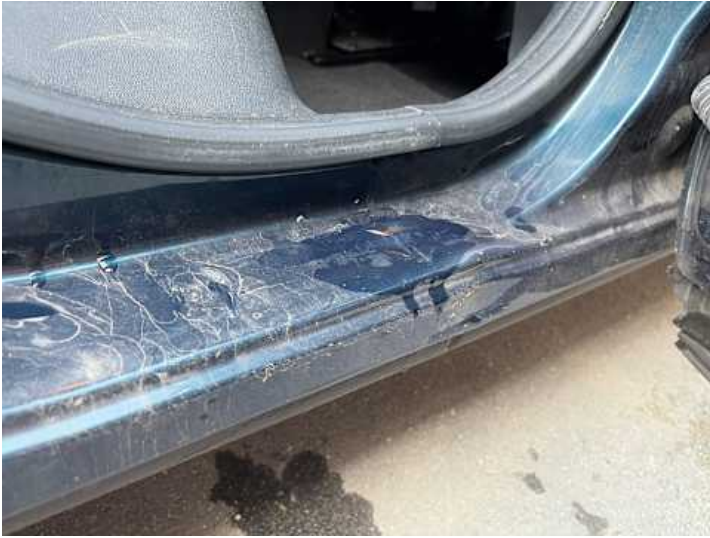
Schweller rechts (Lackschaden, Delle, Verformung)
