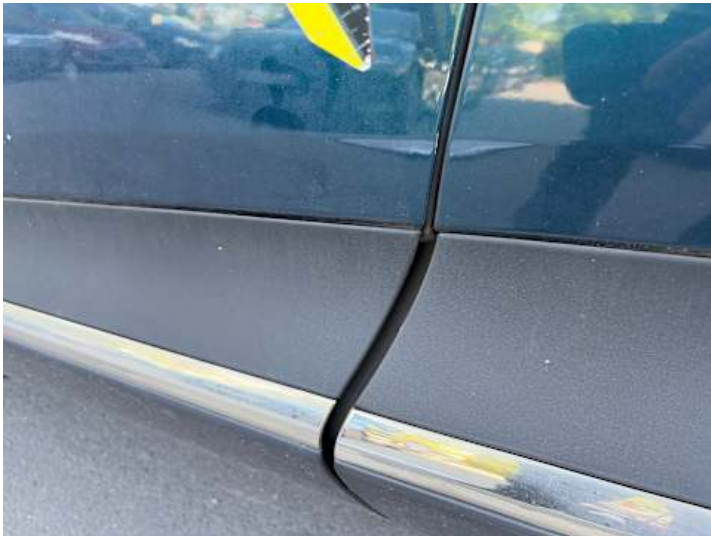
Fahrtür (Lackschaden, Kratzer)
