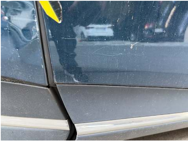
Beifahrertür (Lackschaden, Kratzer)
