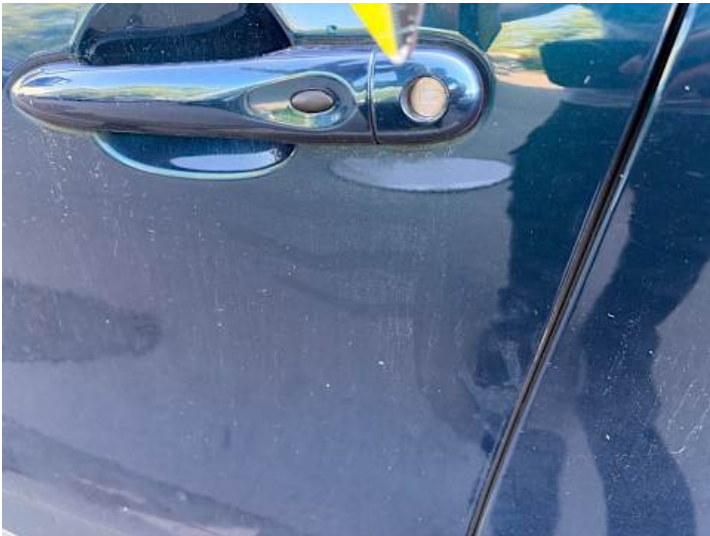
Fahrtür (Lackschaden, Kratzer)
