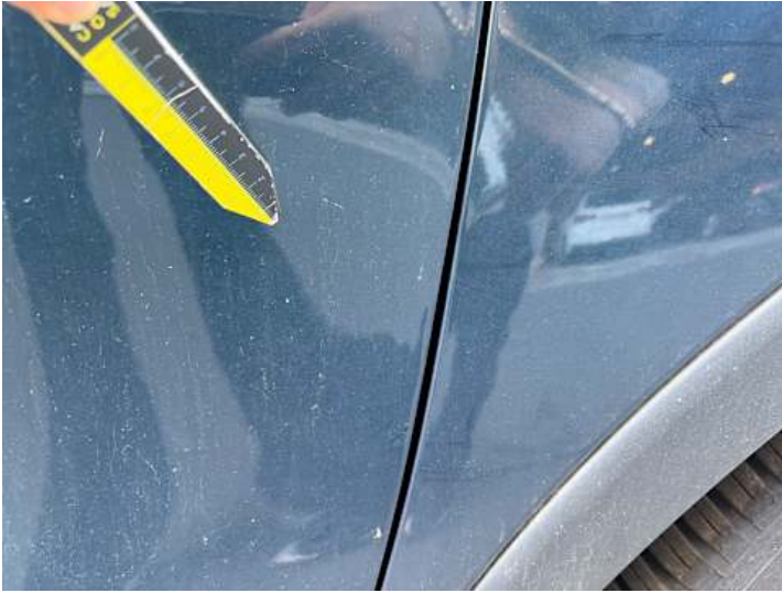
Beifahrertür (Lackschaden, Kratzer)
