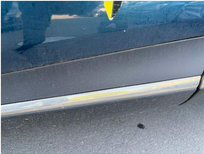
Fahrtür (Lackschaden, Kratzer)
