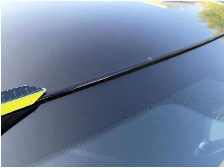
Dach (Lackschaden, Steinschlag)
