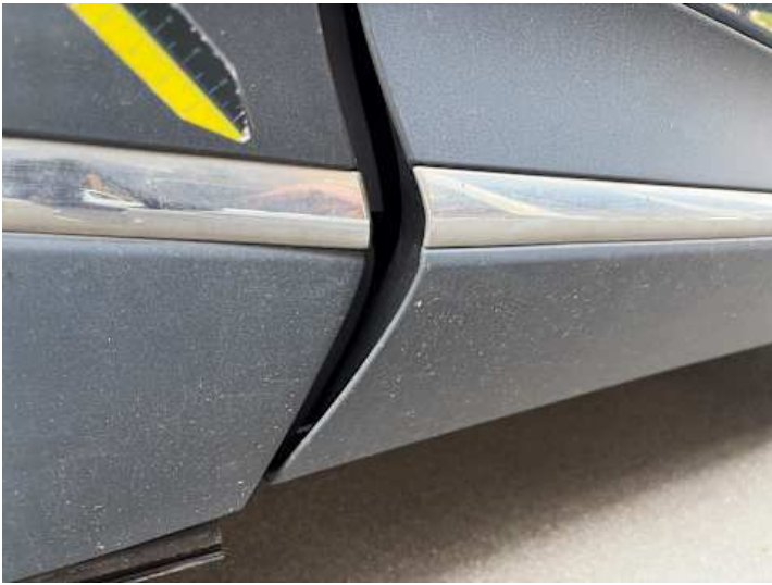
Beifahrertür (Lackschaden, Kratzer)
