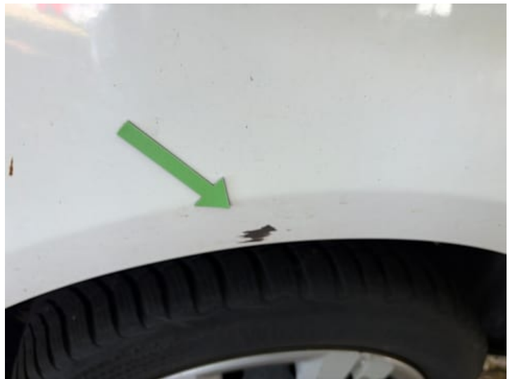
Seitenteil hinten links (Kratzer)
