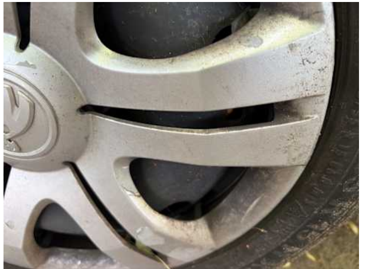
Rad (Riss/Bruch, Kratzer)
