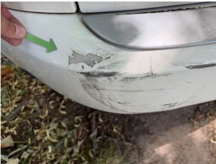
Stoßstange hinten (Riss/Bruch, Kratzer)
