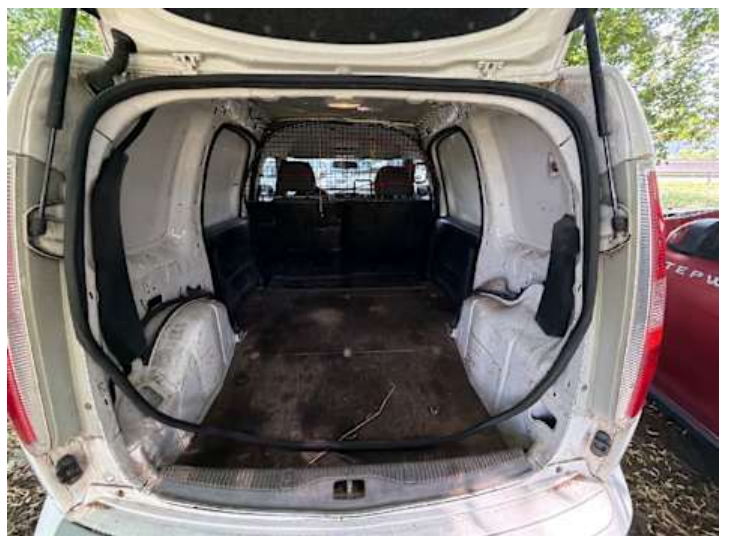
Heckklappe (Anderer Schaden): Dichtung Heckklappe lose
