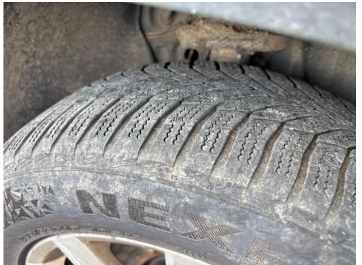
Rad (vehicle.damage-label.porous, Ungleichmäßig abgefahren)
