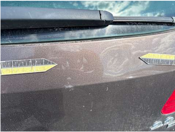
Heckklappe (Delle, Kratzer)
