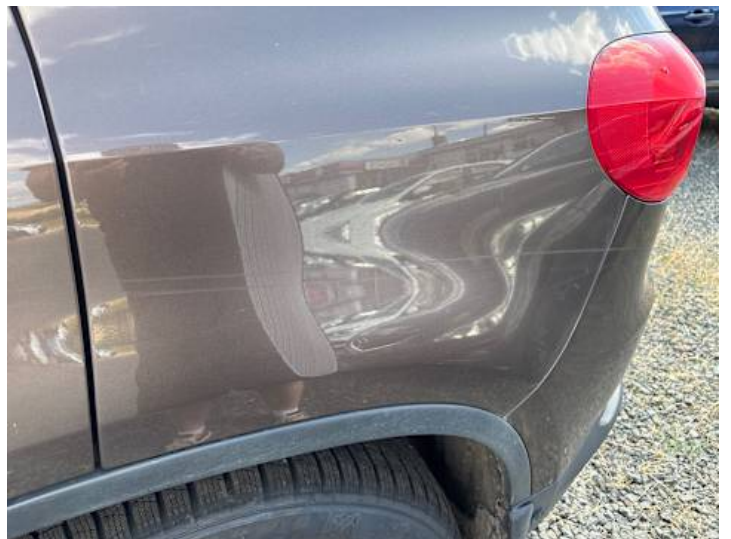
Seitenteil hinten links (Kratzer)
