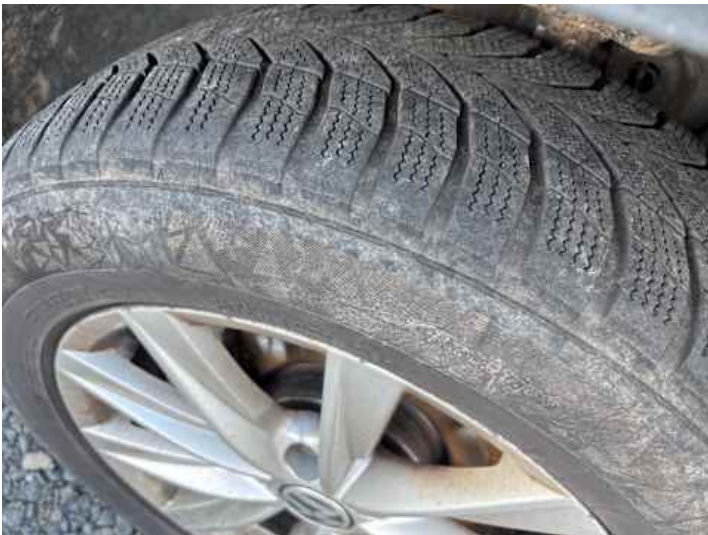
Rad (Ungleichmäßig abgefahren, vehicle.damage-label.porous)
