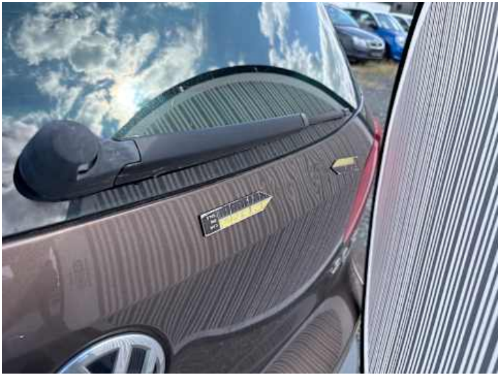
Heckklappe (Delle, Kratzer)
