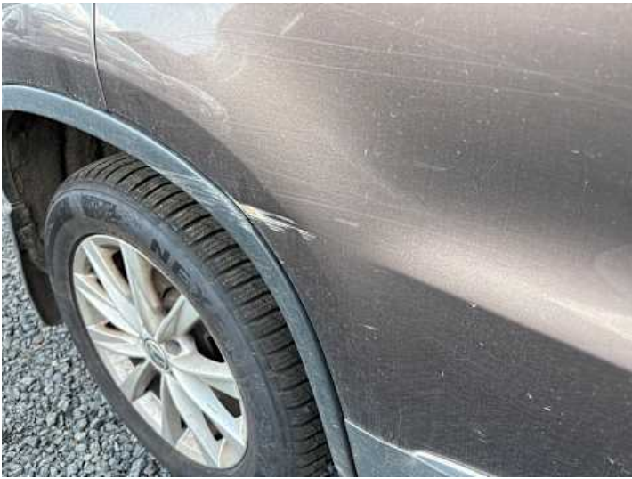
Türe hinten rechts (Kratzer, Rost, Verformung)
