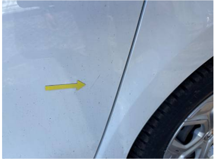
Türe hinten links (Kratzer)
