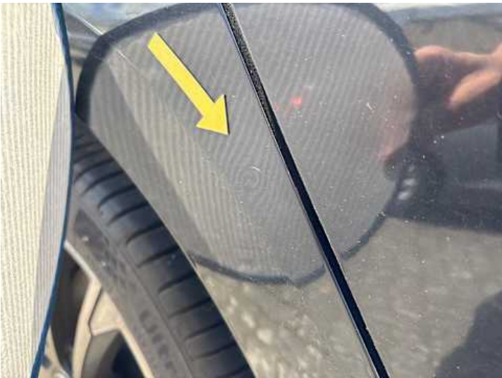
Seitenteil hinten rechts (Delle, Kratzer)
