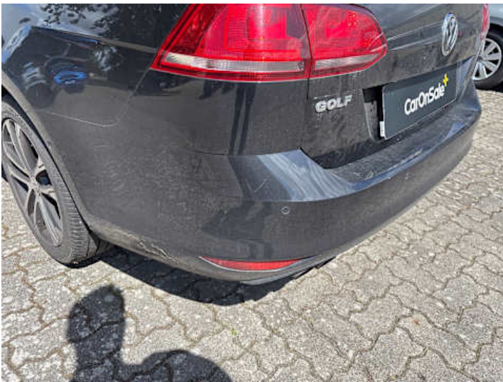
Stoßstange hinten (Kratzer)
