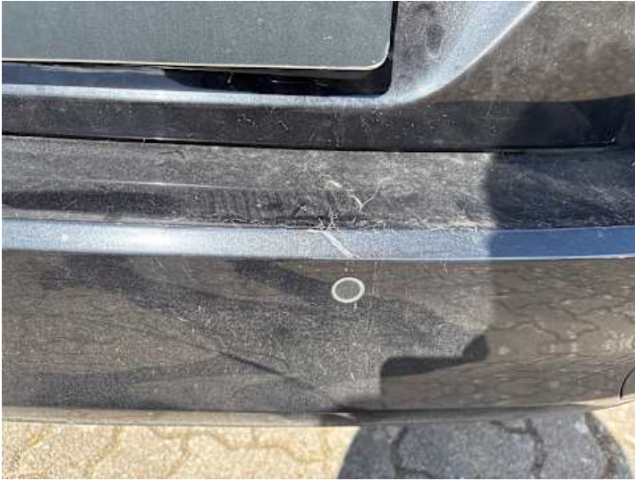
Stoßstange hinten (Kratzer)
