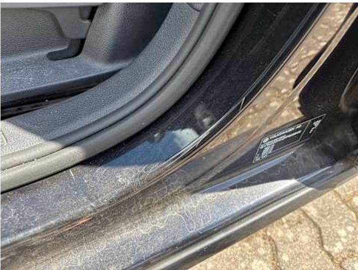
Schweller links (Kratzer)
