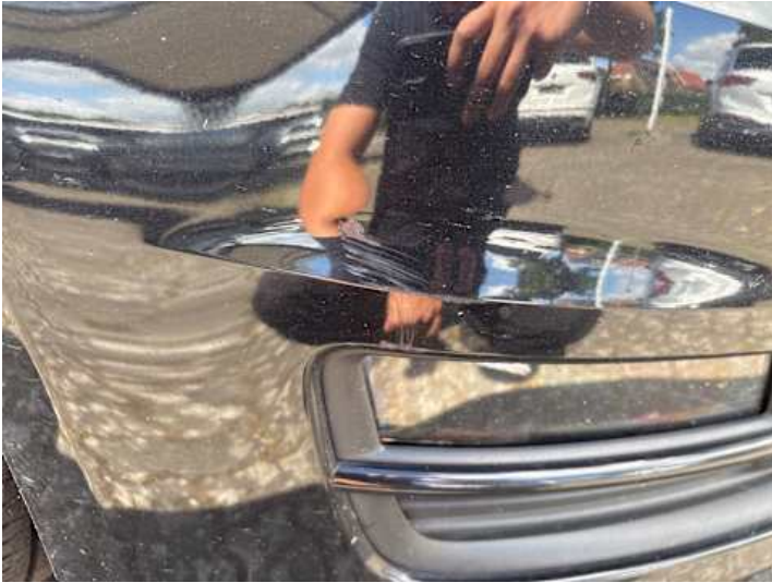
Stoßstange vorne (Lackschaden, Kratzer)
