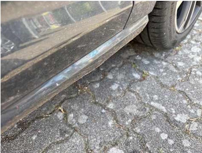
Schweller rechts (Verformung)
