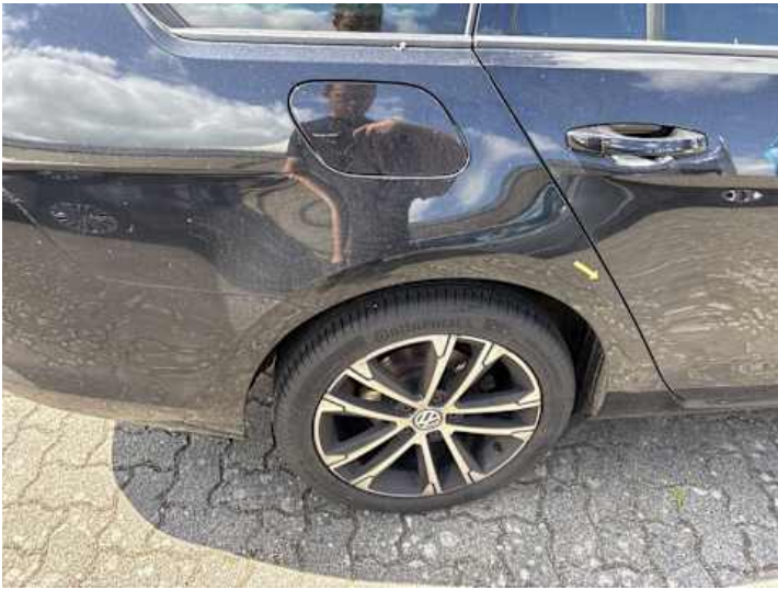
Seitenteil hinten rechts (Delle, Kratzer)
