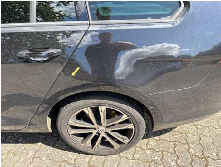
Seitenteil hinten links (Delle)
