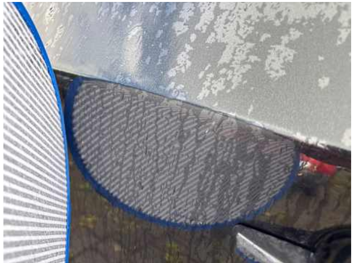
Türe hinten links (Delle)
