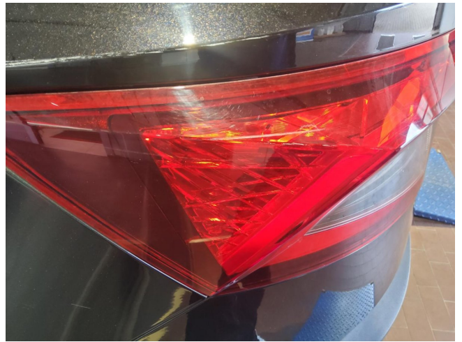
Licht hinten links - Erneuern
