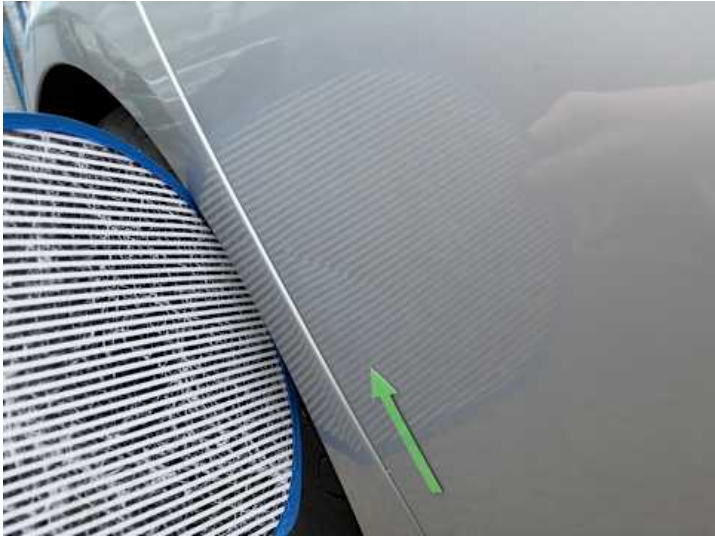
Türe hinten rechts (Delle, Kratzer)
