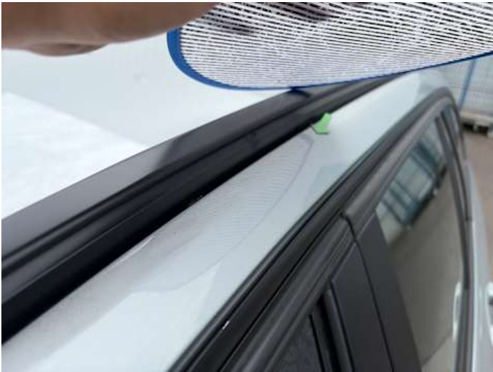
Dach (Delle, Lackschaden)
