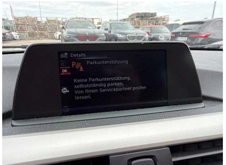
Innenraum (Anderer Schaden): Einparkhilfe ohne Funktion
