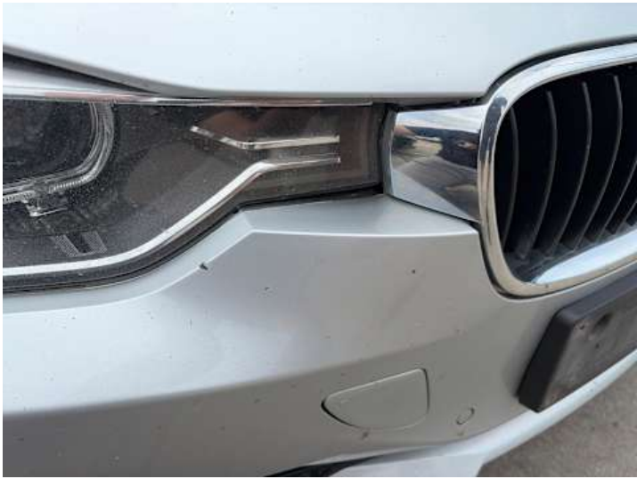
Stoßstange vorne (Spaltmaße ungenau, Kratzer)
