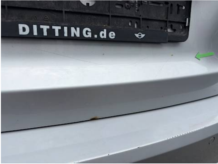
Heckklappe (Kratzer, Rost)
