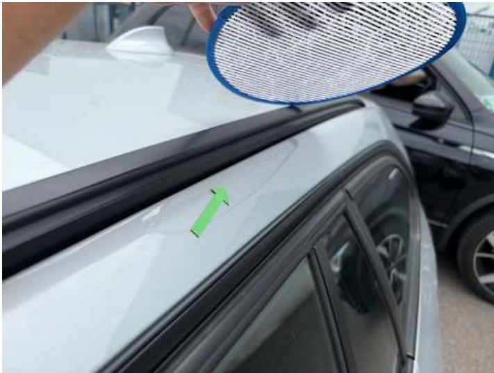
Dach (Delle, Lackschaden)
