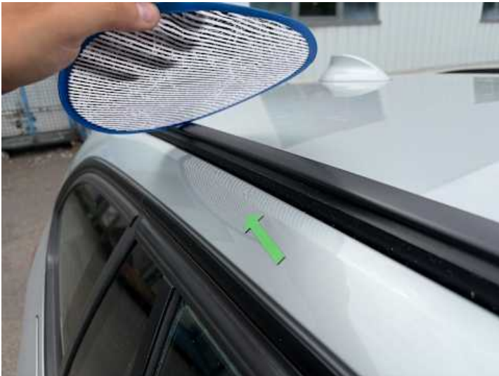
Dach (Delle, Lackschaden)
