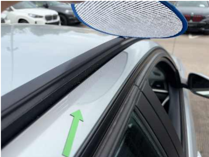
Dach (Delle, Lackschaden)
