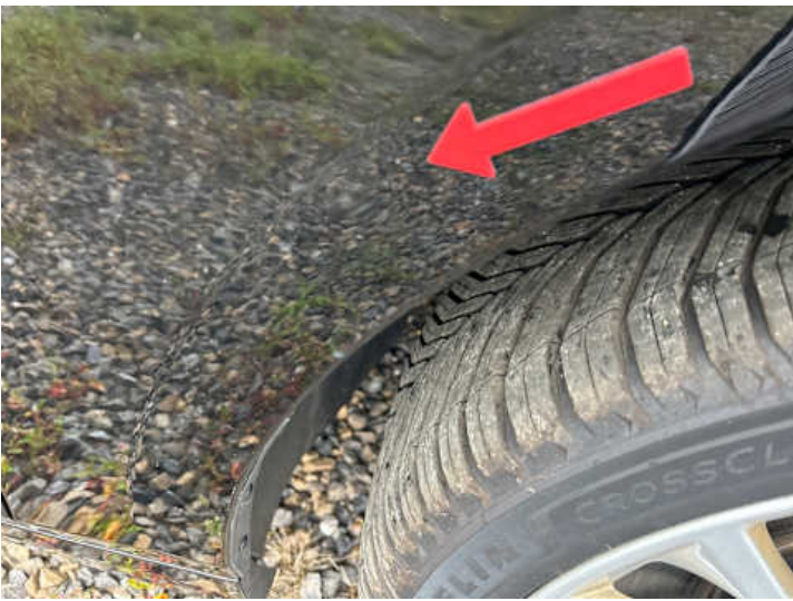
Kotflügel vorne rechts (Kratzer, Delle)
