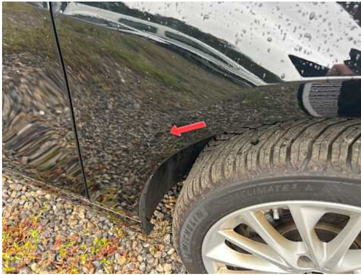
Kotflügel vorne rechts (Kratzer, Delle)
