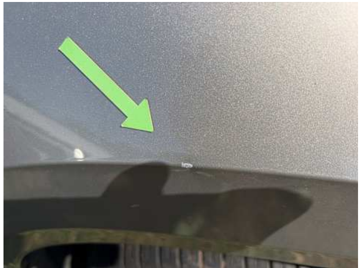
Kotflügel vorne rechts (Lackschaden, Verformung)
