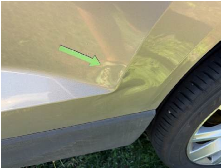
Türe hinten links (Verformung)
