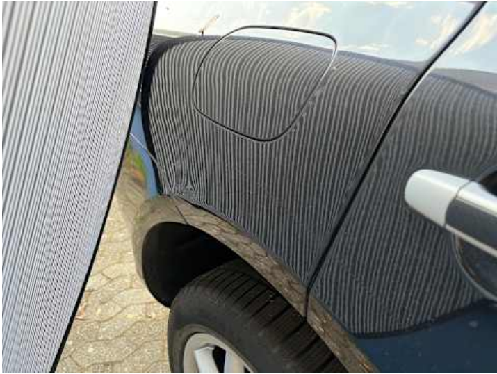
Seitenteil hinten rechts (Lackschaden, Kratzer, Delle, Verformung)
