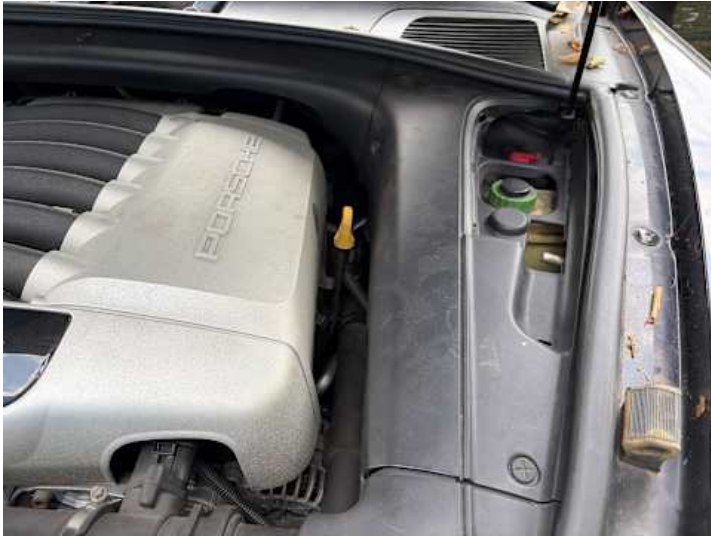
Motorhaube (Anderer Schaden): Kappe fehlt
