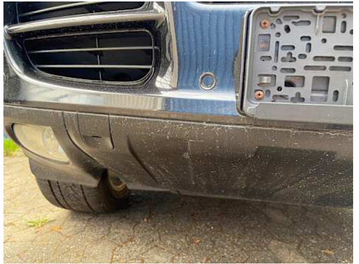
Stoßstange vorne (Lackschaden, Kratzer, Unsachgemäß instand gesetzt)
