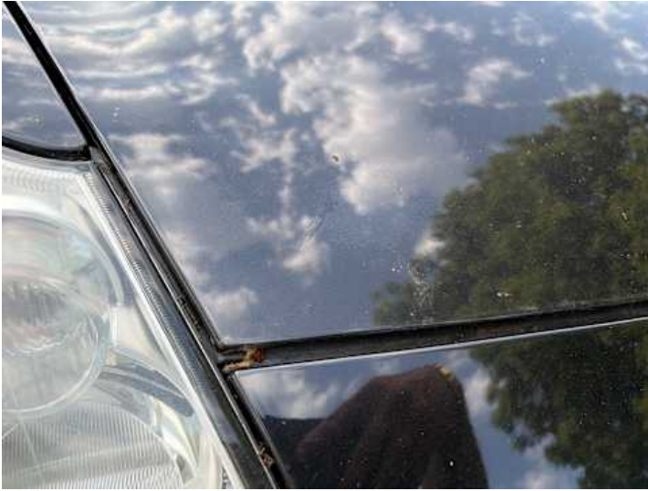
Motorhaube (Lackschaden, Kratzer)
