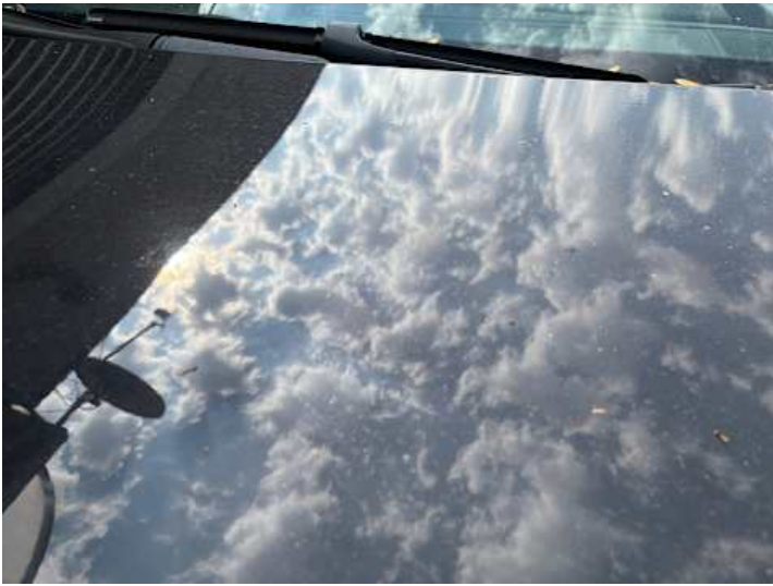
Motorhaube (Lackschaden, Kratzer)
