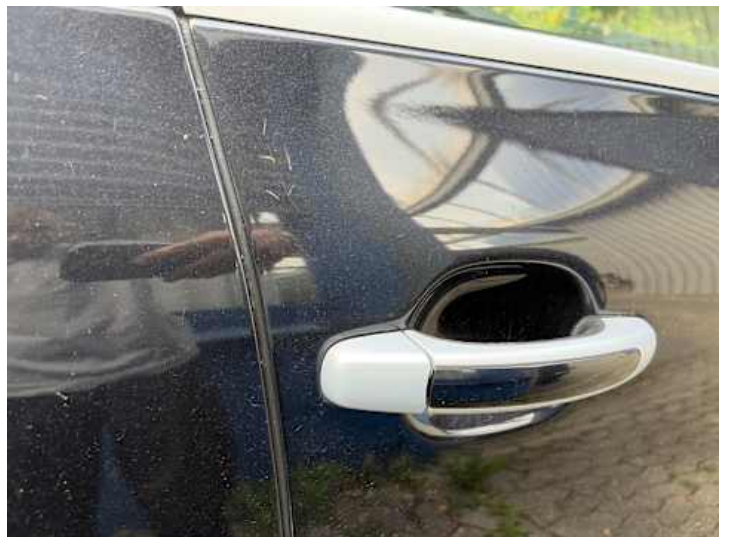
Beifahrtür (Lackschaden, Kratzer)
