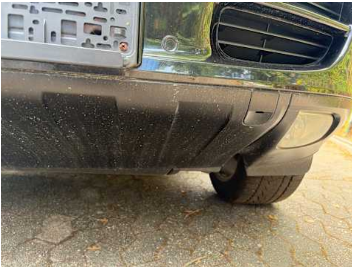
Stoßstange vorne (Lackschaden, Kratzer, Unsachgemäß instand gesetzt)
