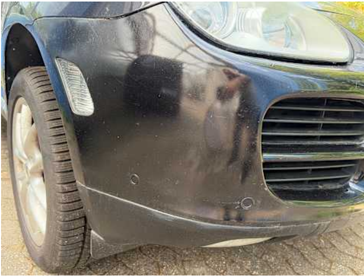
Stoßstange vorne (Lackschaden, Kratzer, Unsachgemäß instand gesetzt)
