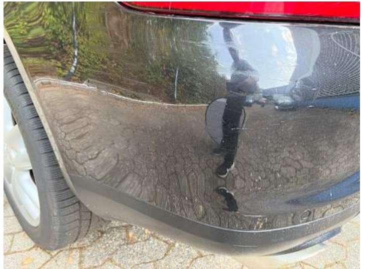
Stoßstange hinten (Lackschaden, Kratzer, Unsachgemäß instand gesetzt)
