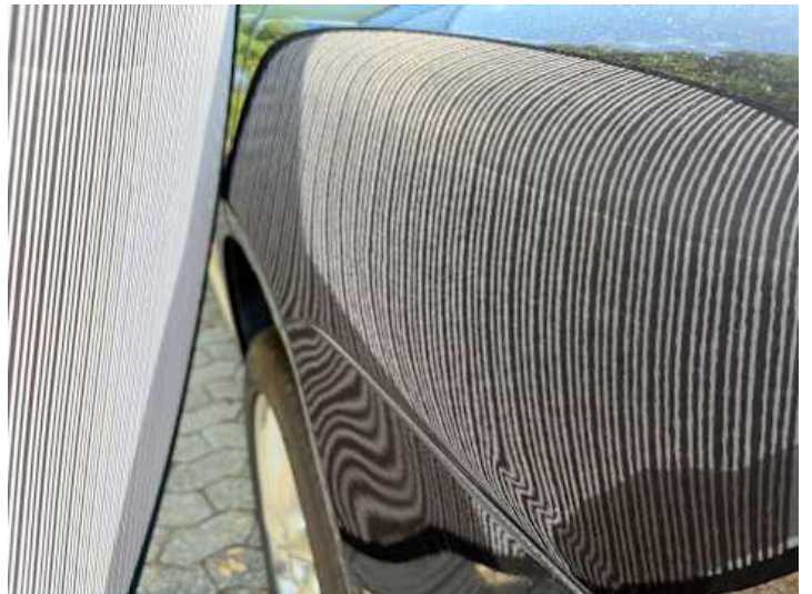
Seitenteil hinten links (Delle, Verformung)
