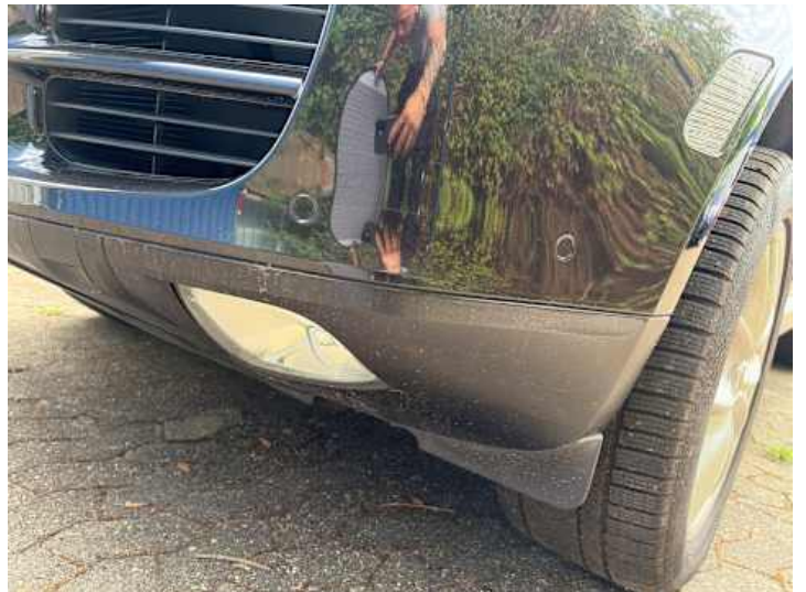
Stoßstange vorne (Lackschaden, Kratzer, Unsachgemäß instand gesetzt)
