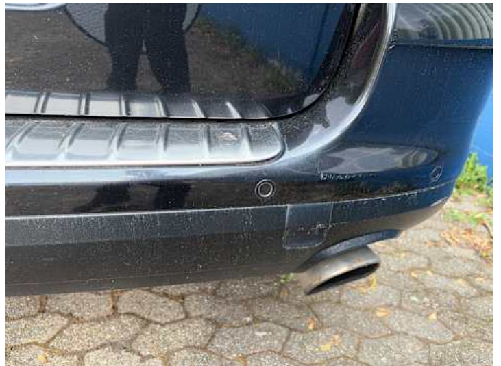
Stoßstange hinten (Lackschaden, Kratzer, Unsachgemäß instand gesetzt)
