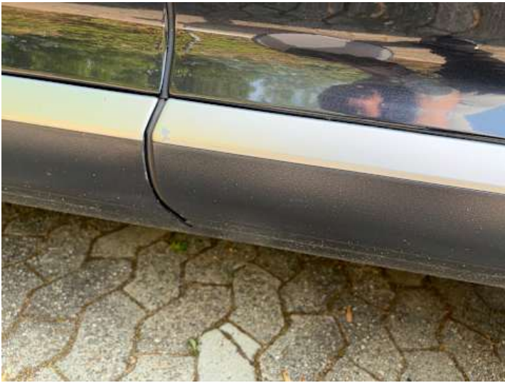
Türe hinten links (Lackschaden, Kratzer)
