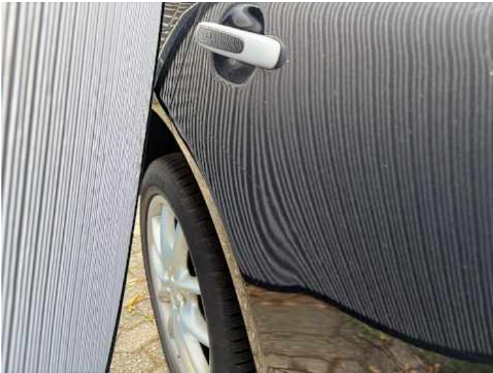
Türe hinten rechts (Delle)
