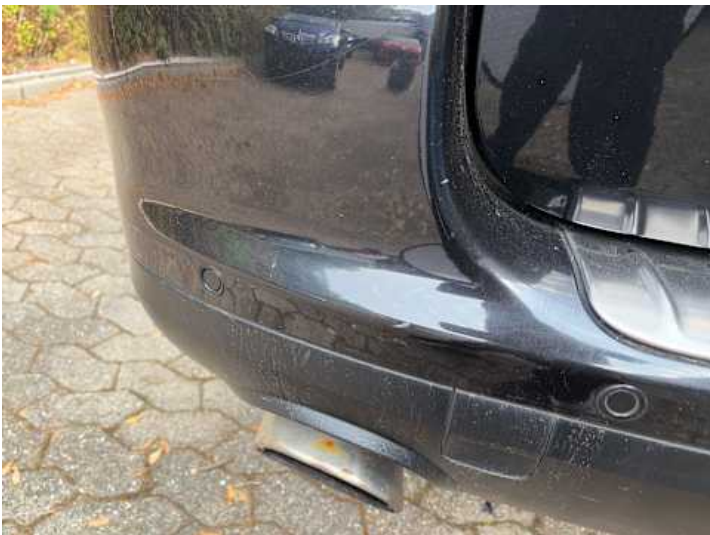
Stoßstange hinten (Lackschaden, Kratzer, Unsachgemäß instand gesetzt)
