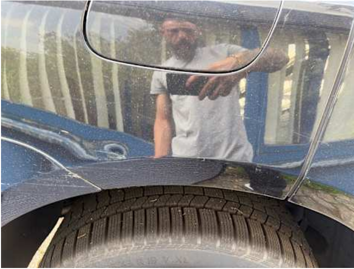
Seitenteil hinten rechts (Lackschaden, Kratzer, Delle, Verformung)
