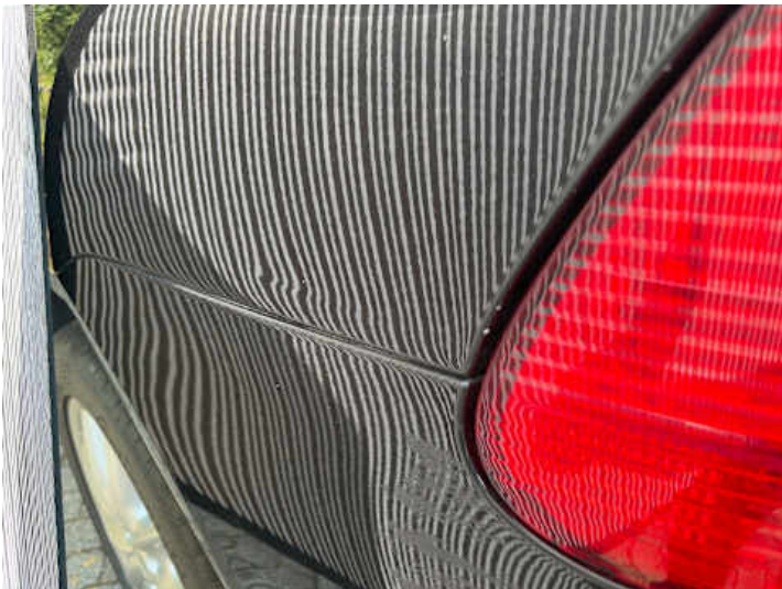
Seitenteil hinten links (Delle, Verformung)
