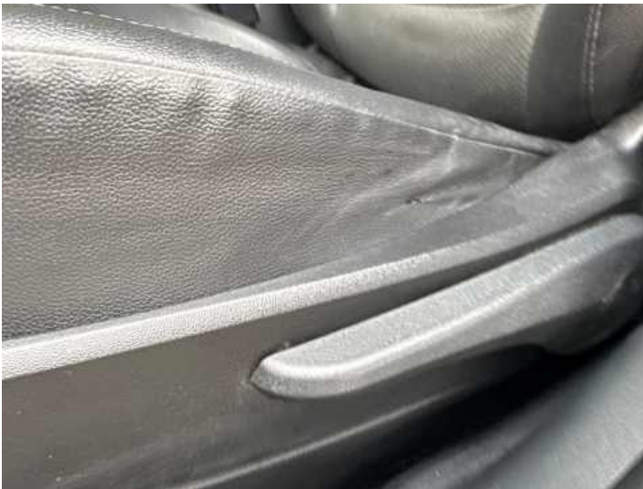
Innenraum (Verschleiß, Riss/Bruch)
