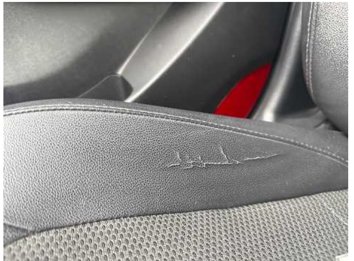
Innenraum (Verschleiß, Riss/Bruch)
