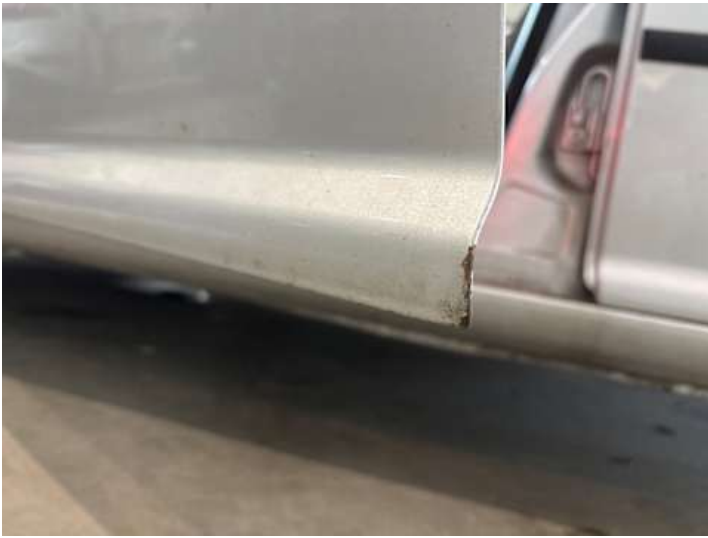
Fahrer ­ tür (Lackschaden, Rost, Kratzer)
