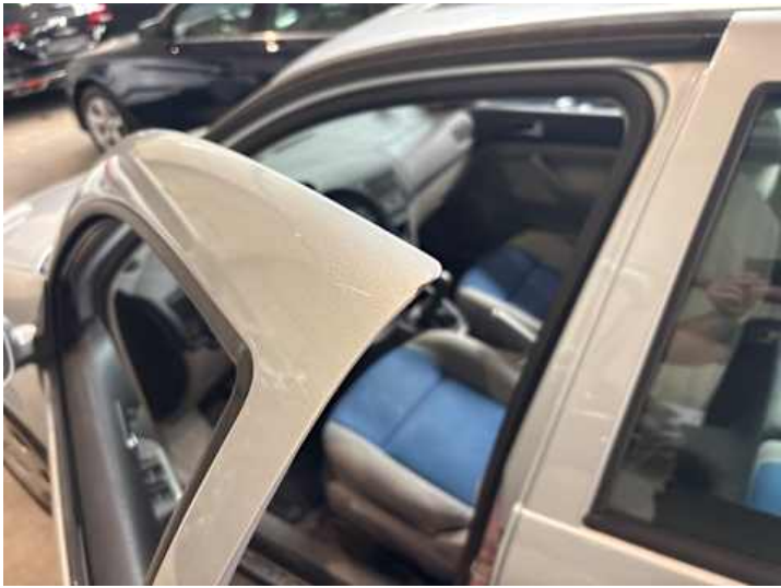
Fahrer ­ tür (Lackschaden, Rost, Kratzer)
