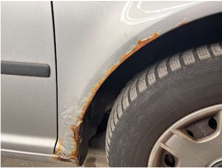
Kotflügel vorne rechts (Lackschaden, Rost)
