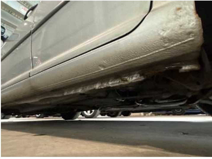
Schweller links (Rost, Lackschaden, Riss/Bruch, Verformung)
