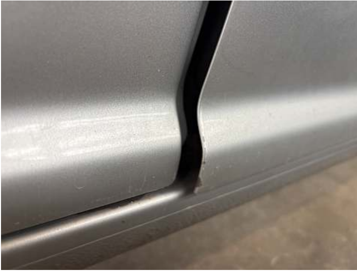
Beifahrer ­ tür (Lackschaden, Rost)
