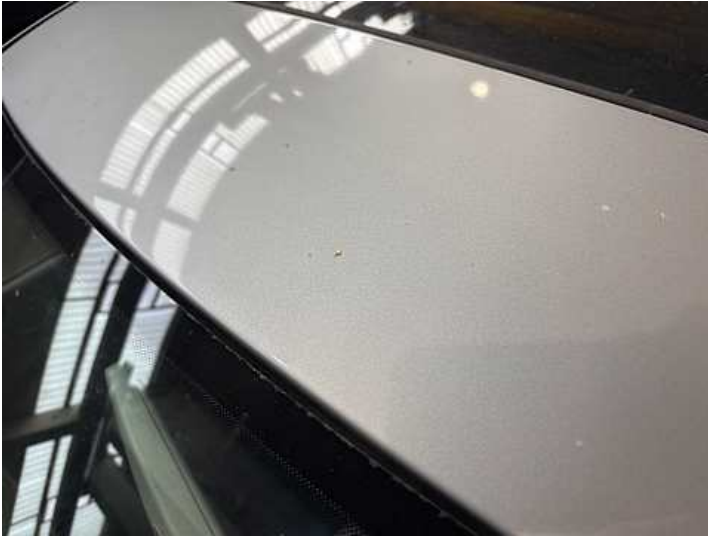
Dach (Steinschlag, Rost, Lackschaden)
