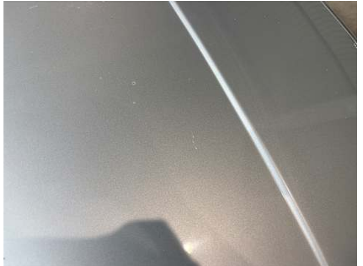
Motorhaube (Steinschlag, Rost)
