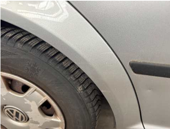
Seitenteil hinten rechts (Delle, Kratzer, Lackschaden)
