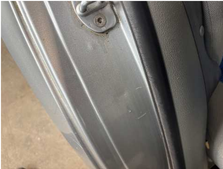
Seitenteil hinten rechts (Delle, Kratzer, Lackschaden)
