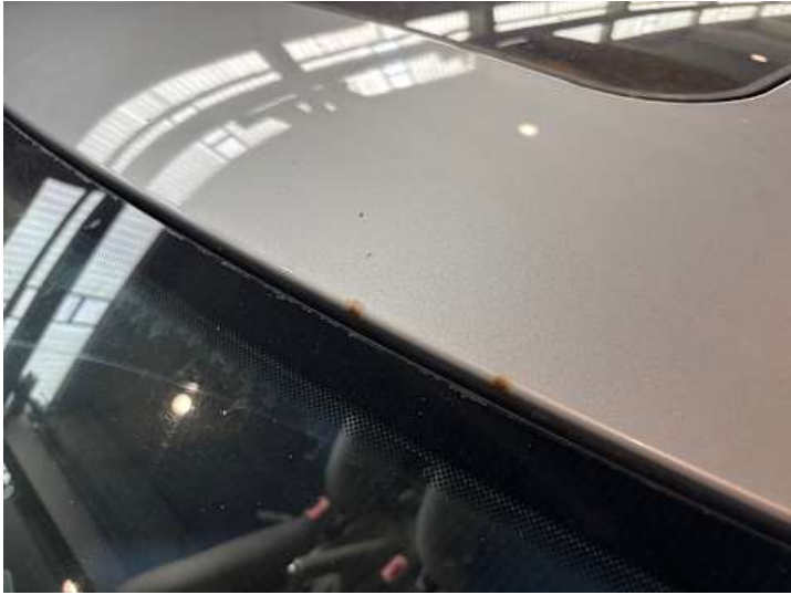
Dach (Steinschlag, Rost, Lackschaden)
