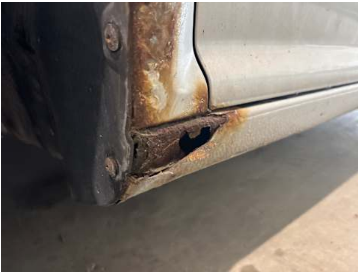
Schweller links (Rost, Lackschaden, Riss/Bruch, Verformung)
