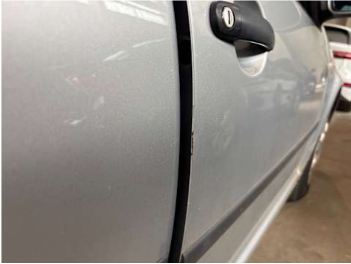
Beifahrer ­ tür (Lackschaden, Rost)
