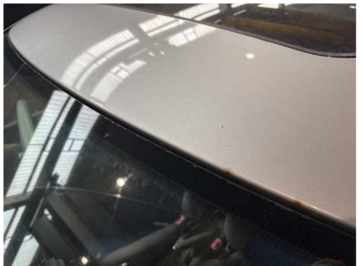
Windschutzscheibe (Anderer Schaden): Ablösung
