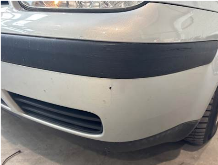
Stoßstange vorne (Kratzer, Lackschaden, Riss/Bruch, Unsachgemäß instand gesetzt)
