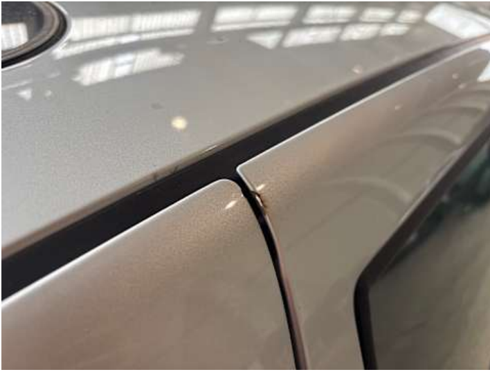
Türe hinten links (Delle, Lackschaden, Rost, Kratzer)
