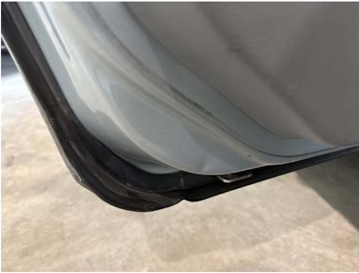
Türe hinten links (Delle, Lackschaden, Rost, Kratzer)
