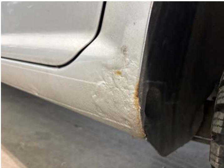
Schweller links (Rost, Lackschaden, Riss/Bruch, Verformung)
