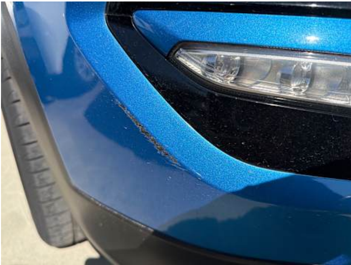
Stoßstange vorne (Kratzer, Lackschaden)
