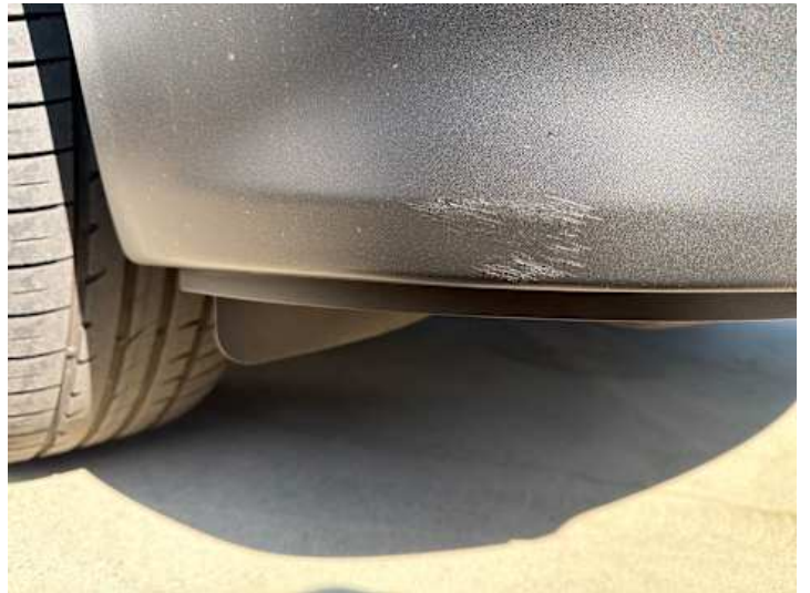
Stoßstange vorne (Kratzer, Lackschaden)
