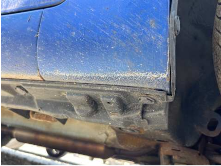
Kotflügel vorne rechts (Rost, Lackschaden)
