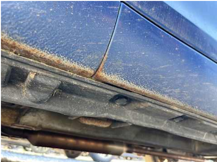
Schweller links (Rost, Lackschaden)
