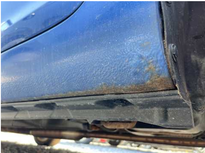
Schweller links (Rost, Lackschaden)
