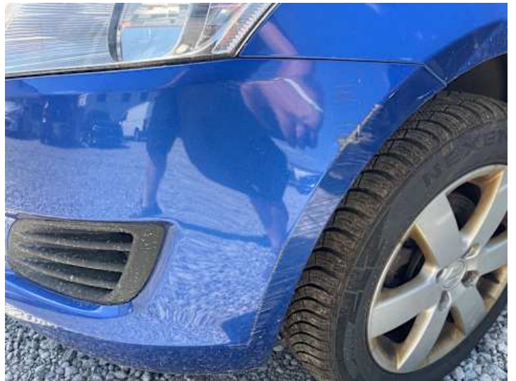
Stoßstange vorne (Lackschaden, Kratzer)
