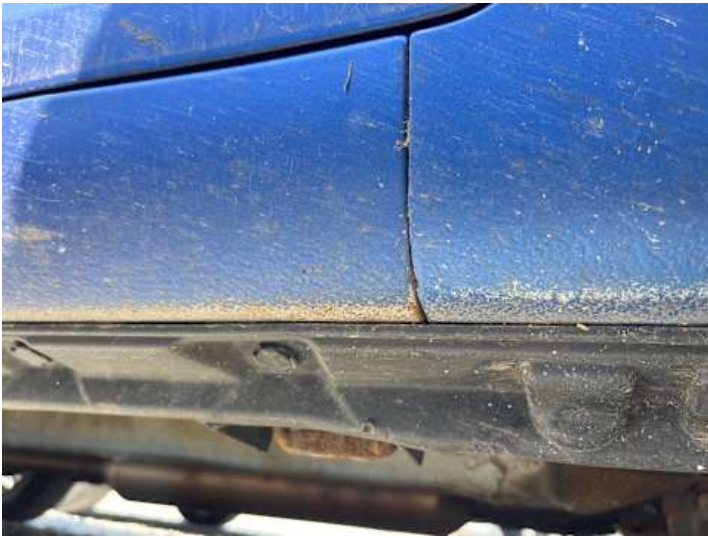
Schweller rechts (Rost, Lackschaden)
