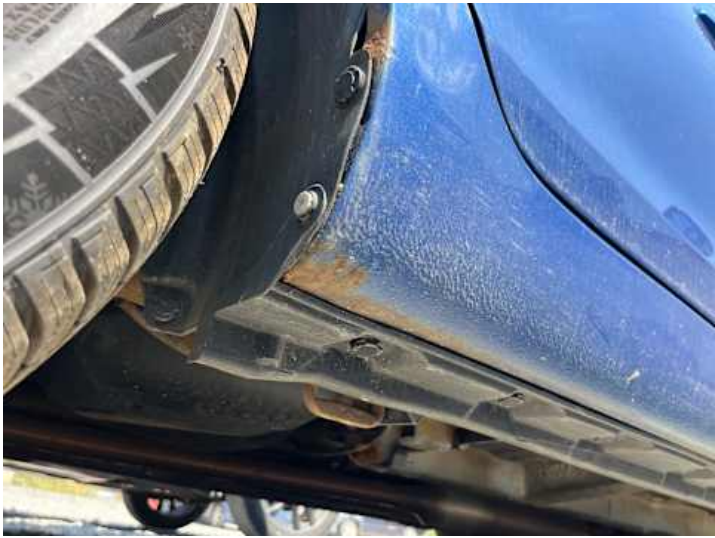
Schweller rechts (Rost, Lackschaden)
