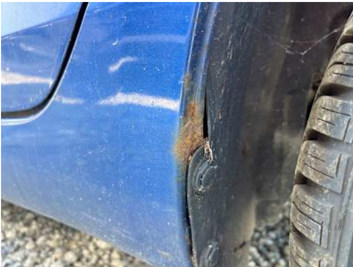
Schweller links (Rost, Lackschaden)
