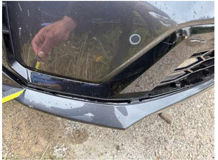
Stoßstange vorne (Riss/Bruch)
