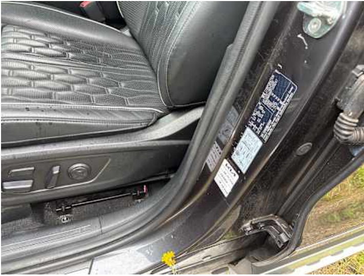
Schweller links (Kratzer, Delle)
