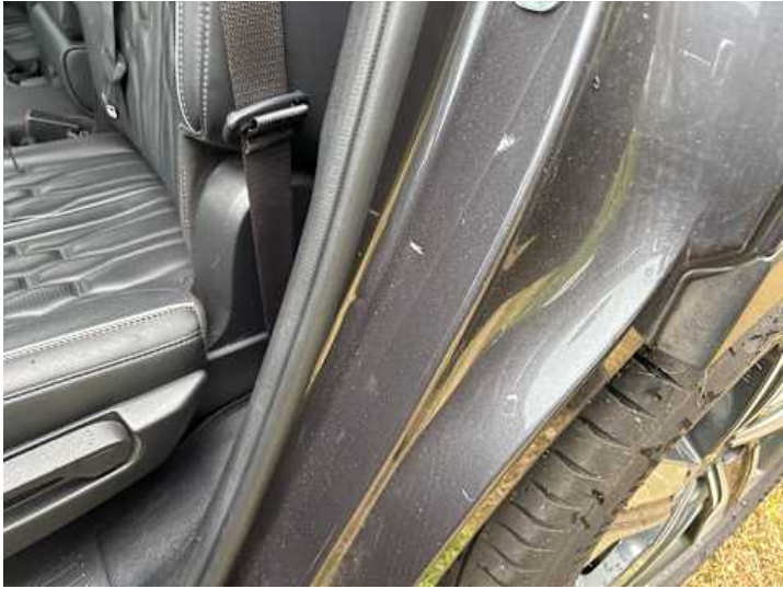
Schweller links (Kratzer, Delle)
