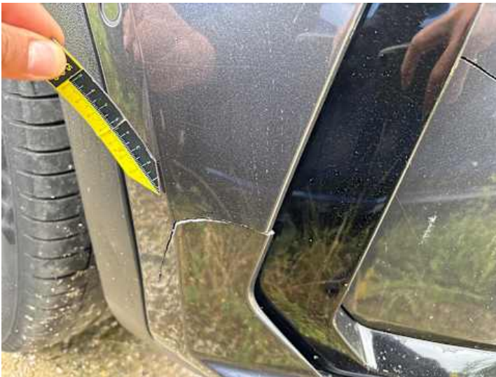
Stoßstange vorne (Riss/Bruch)
