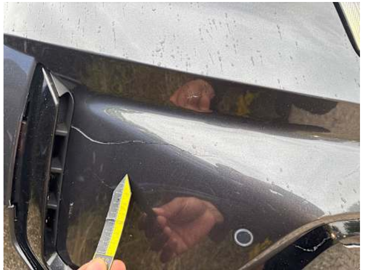
Stoßstange vorne (Riss/Bruch)
