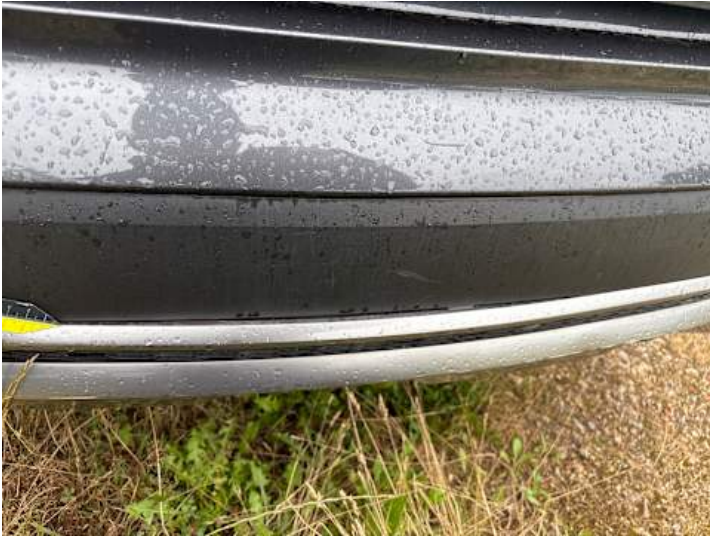
Stoßstange hinten (Kratzer, Spaltmaße ungenau)
