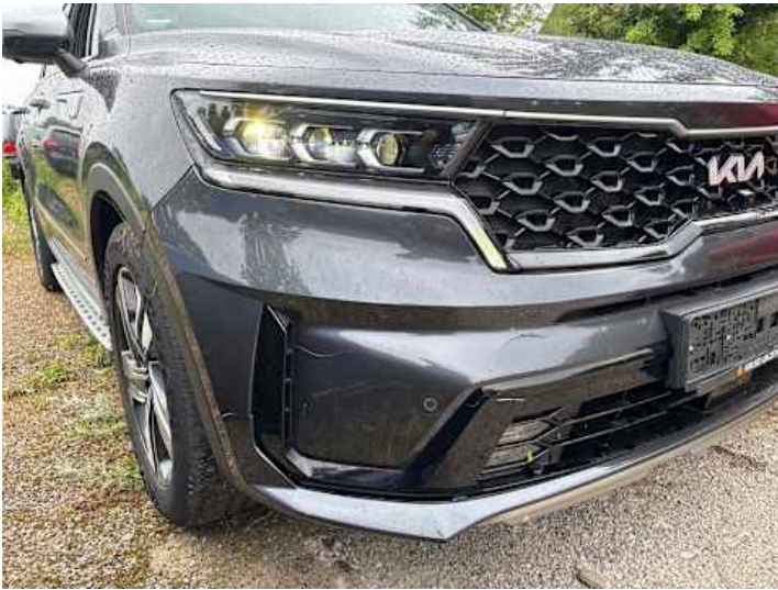
Stoßstange vorne (Riss/Bruch)
