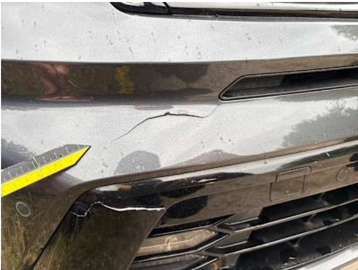
Stoßstange vorne (Riss/Bruch)
