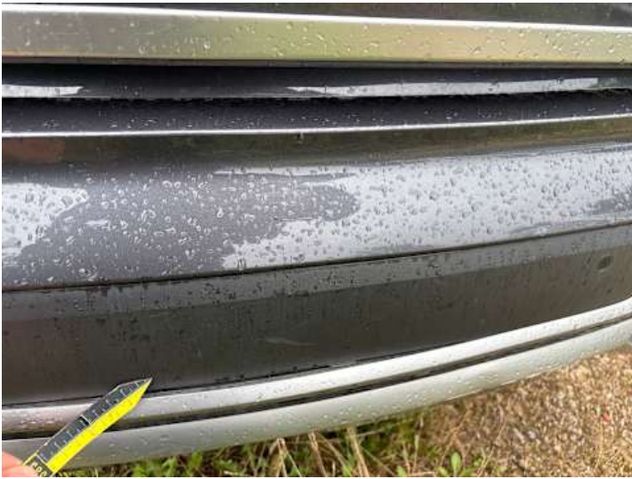
Stoßstange hinten (Kratzer, Spaltmaße ungenau)
