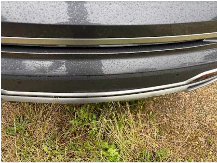
Stoßstange hinten (Kratzer, Spaltmaße ungenau)
