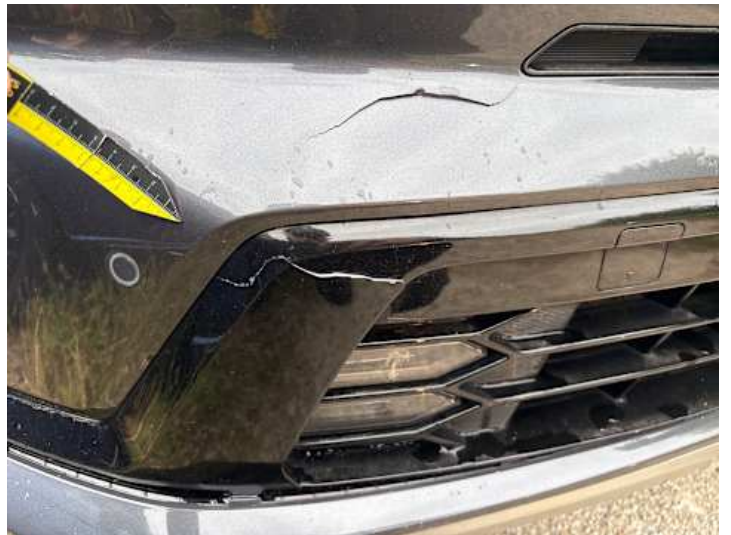
Stoßstange vorne (Riss/Bruch)
