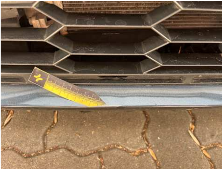
Stoßstange vorne (Verformung)
