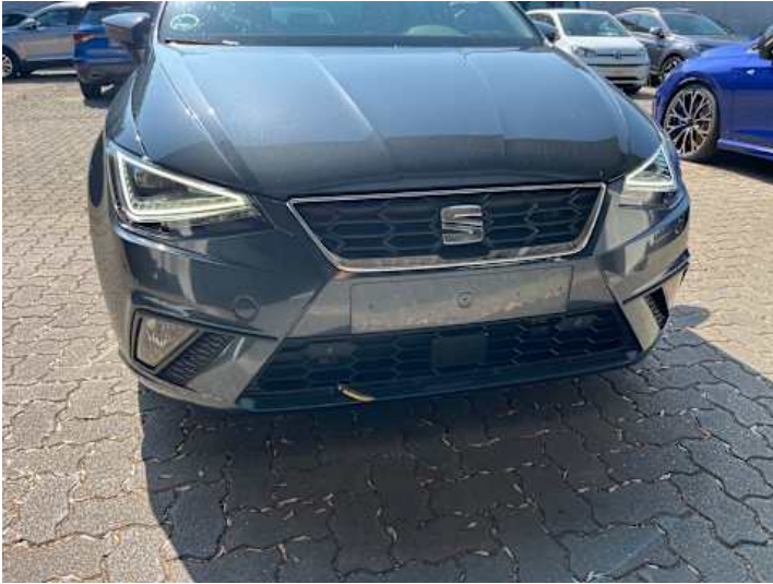
Stoßstange vorne (Verformung)
