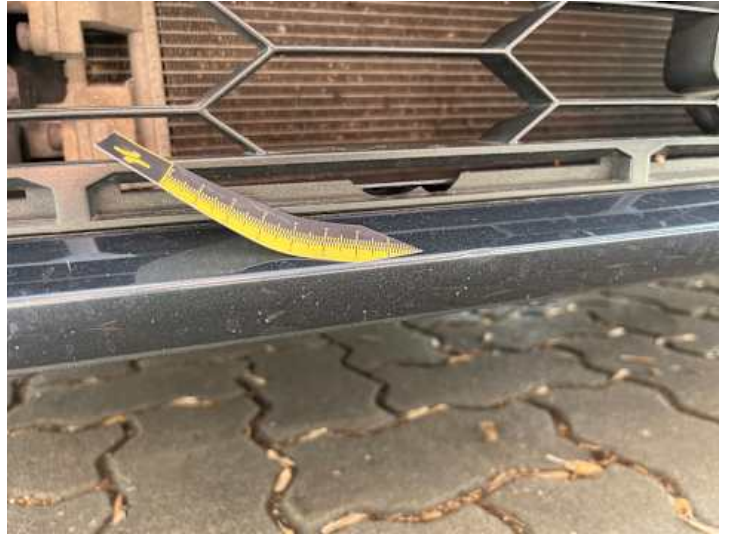
Stoßstange vorne (Verformung)
