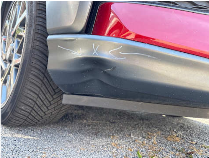
Stoßstange vorne (Verformung)
