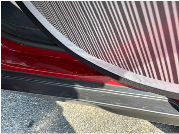
Schweller links (Lackschaden, Delle)
