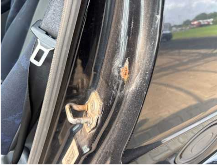
Seitenteil hinten links (Lackschaden, Rost)
