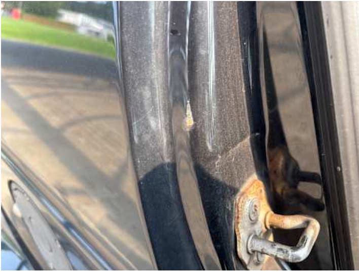
Seitenteil hinten rechts (Rost, Lackschaden)
