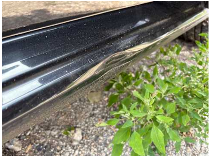
Schweller rechts (Verformung)
