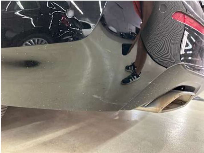
Stoßstange hinten (Kratzer)
