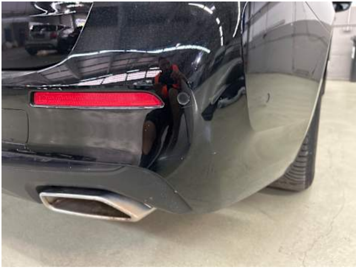
Stoßstange hinten (Kratzer)
