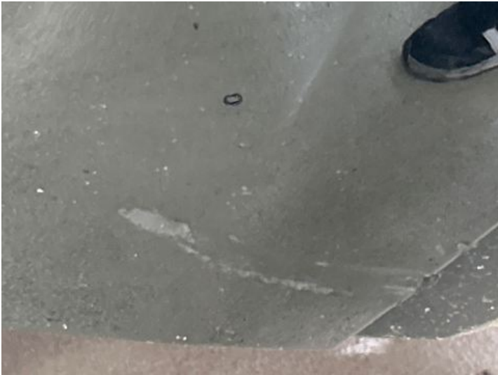
Stoßstange hinten (Kratzer)
