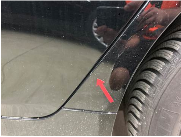
Seitenteil hinten links (Lackschaden)
