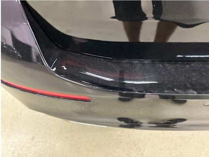
Stoßstange hinten (Kratzer)
