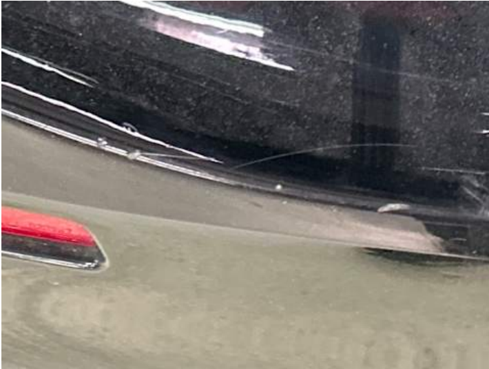
Stoßstange hinten (Kratzer)
