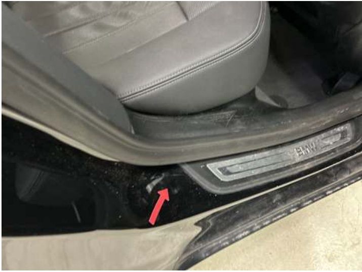
Schweller rechts (Kratzer)
