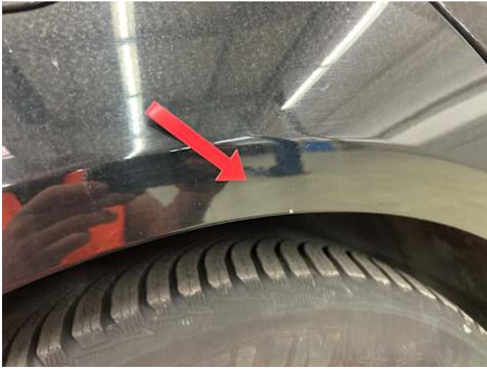
Seitenteil hinten rechts (Kratzer)
