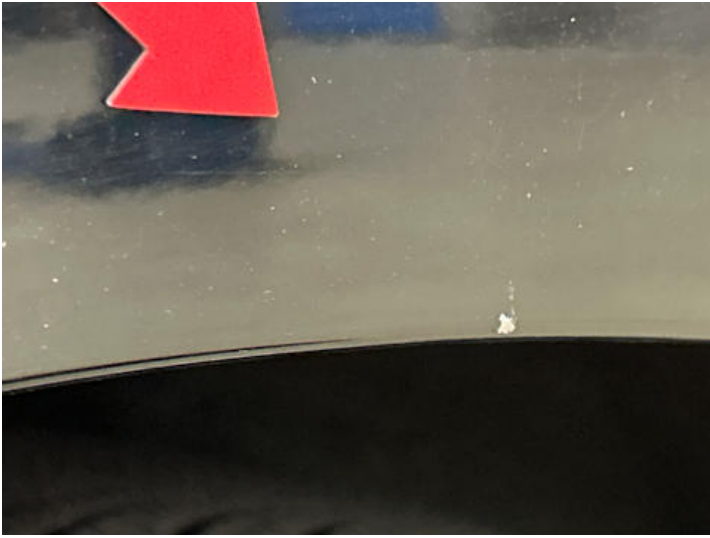
Seitenteil hinten rechts (Kratzer)
