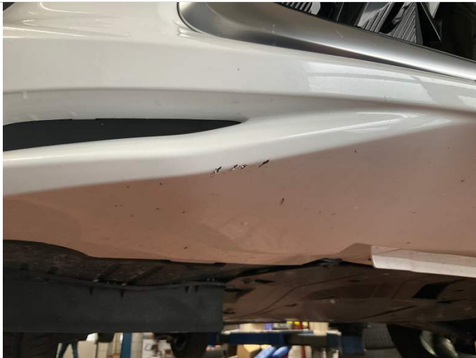
Stoßfänger vorne rechts unten Kratzer
