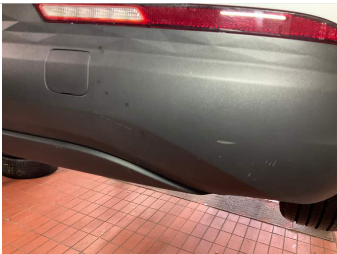
Stoßfängerschürze hinten Kratzer
