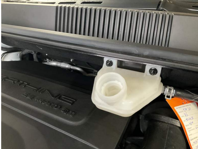
Bremsschlauchbehälter Deckel fehlt
