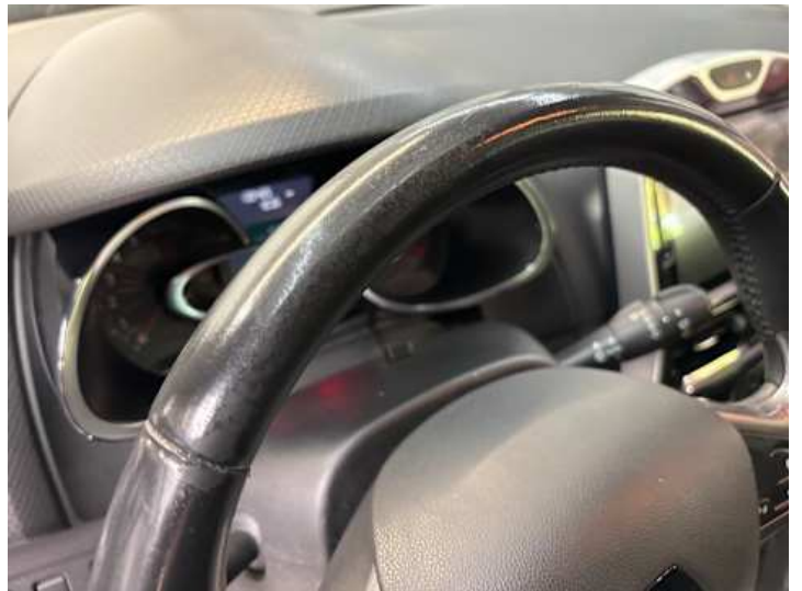
Innenraum (Verschmutzung, Verschleiß)
