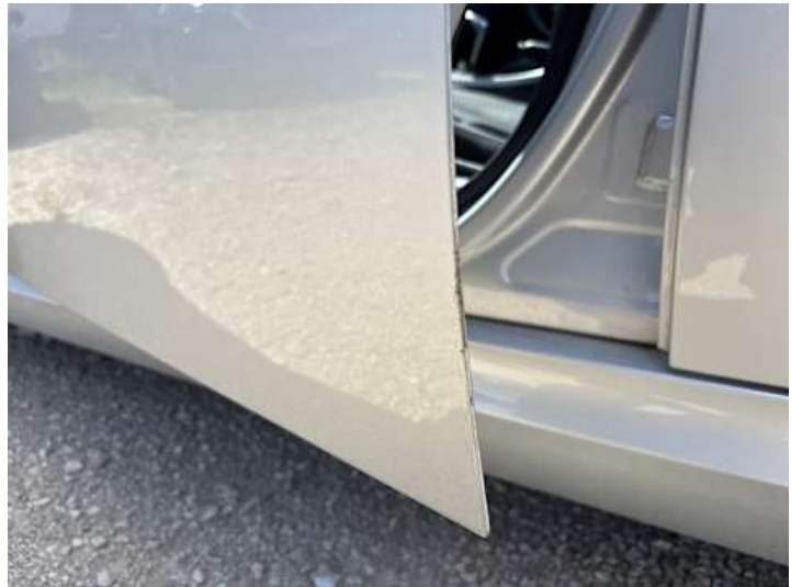
Fahrertür (Kratzer, Rost)
