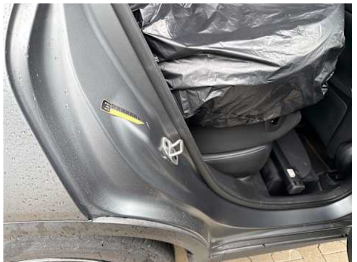
Türe hinten rechts (Kratzer, Delle)
