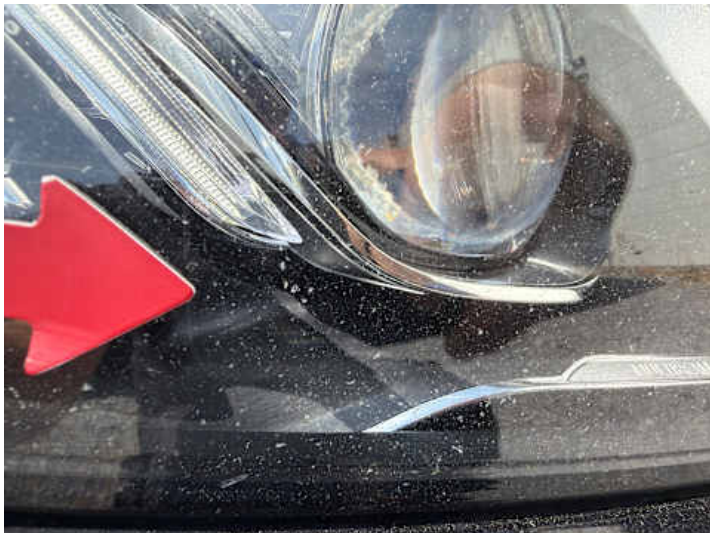
Scheinwerfer (rechts) (Steinschlag)
