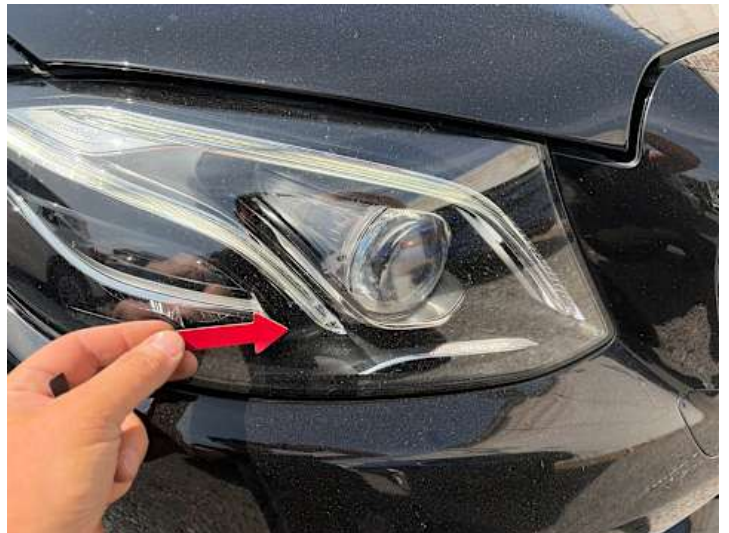
Scheinwerfer (rechts) (Steinschlag)
