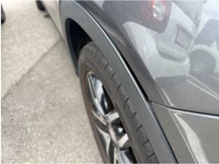
Seitenteil hinten links (Riss/Bruch)
