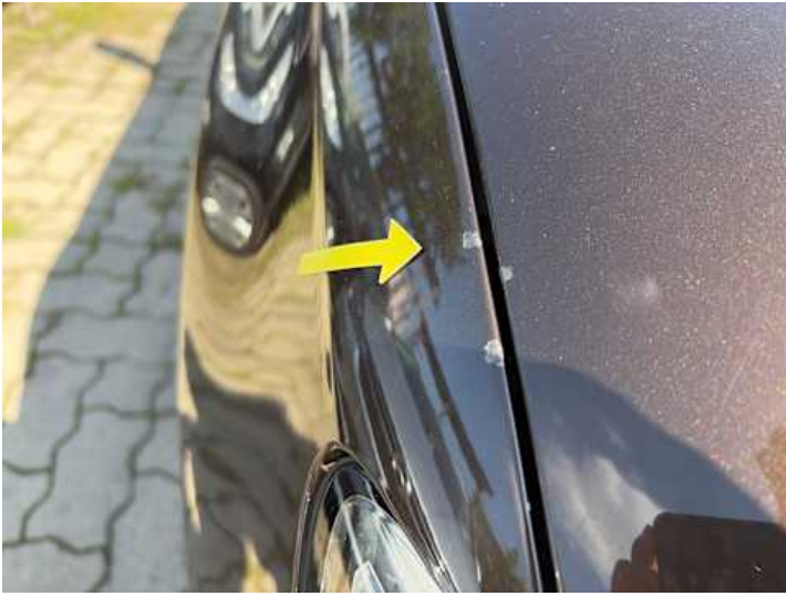
Kotflügel vorne rechts (Lackschaden)
