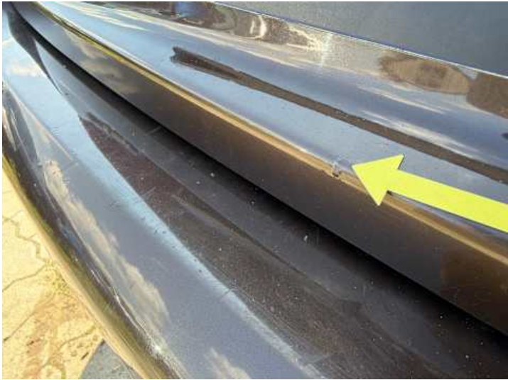
Heckklappe (Lackschaden, Kratzer, Delle)
