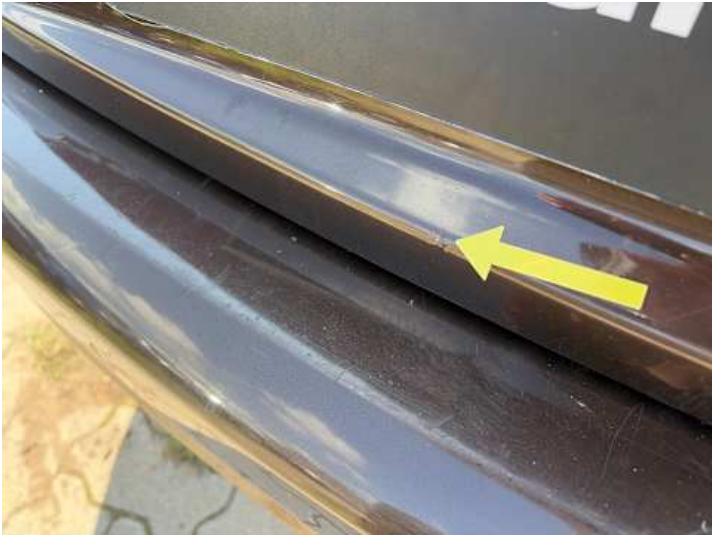
Heckklappe (Lackschaden, Kratzer, Delle)
