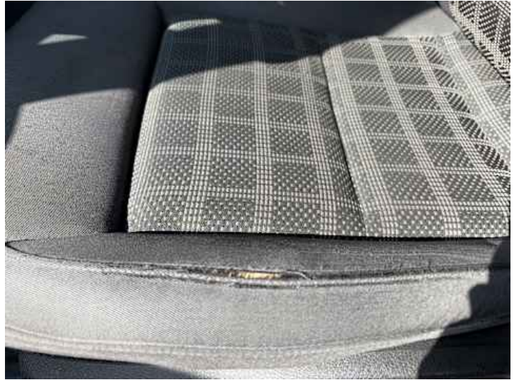
Innenraum (Verschleiß, Riss/Bruch)
