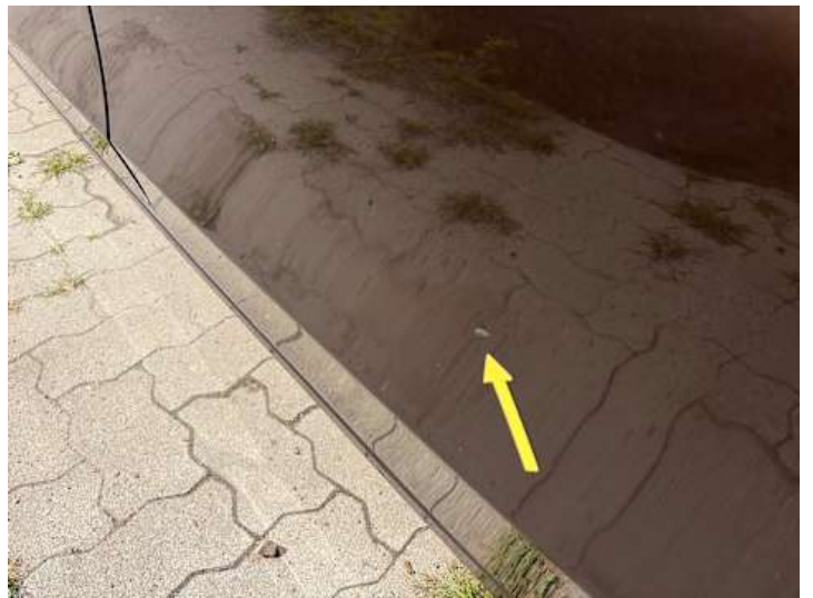
Türe hinten links (Lackschaden)
