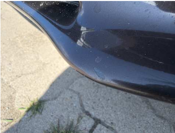
Stoßstange vorne (Kratzer, Verformung)
