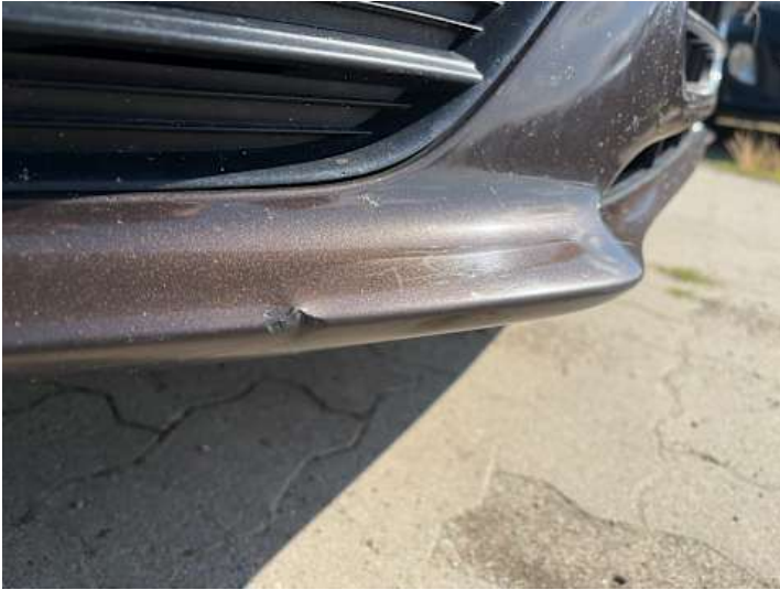
Stoßstange vorne (Kratzer, Verformung)
