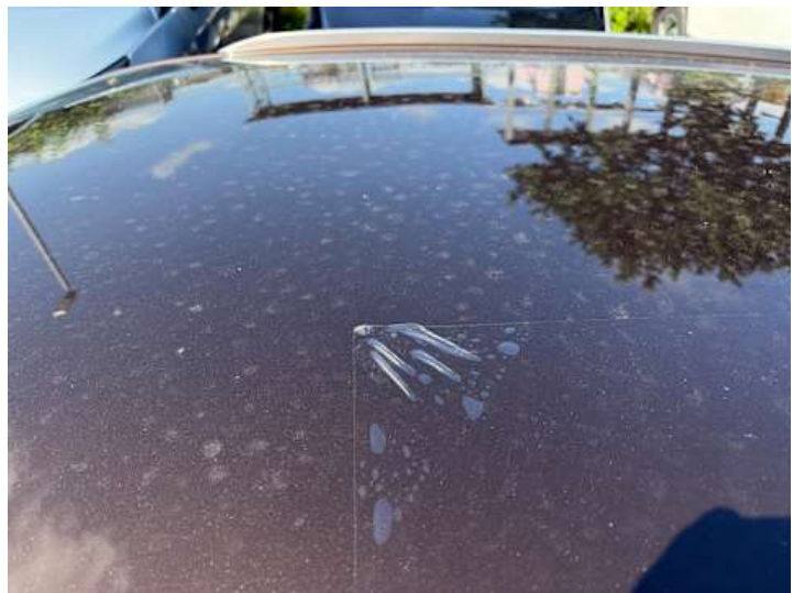
Dach (Kratzer, Anderer Schaden): Folie
