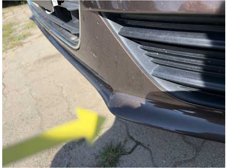
Stoßstange vorne (Kratzer, Verformung)
