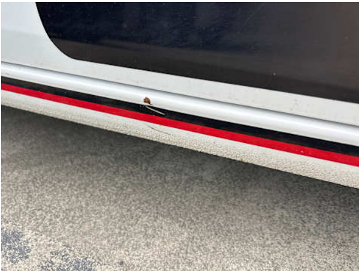
Schweller rechts (Verformung, Kratzer, Rost)
