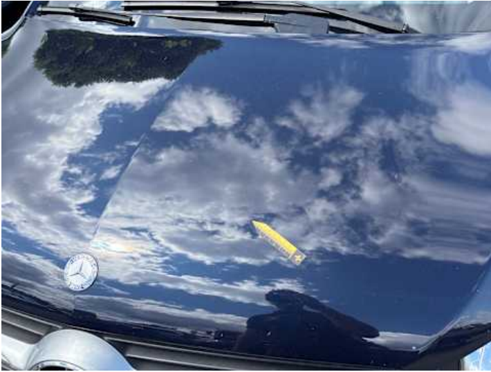
Motorhaube (Unsachgemäß instand gesetzt, Lackschaden)
