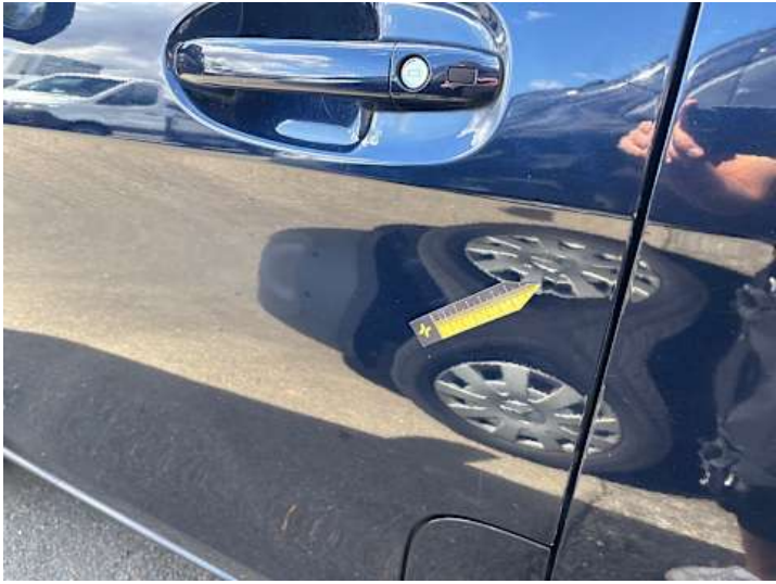
Fahrtür (Verformung, Delle)
