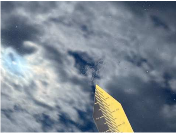
Motorhaube (Unsachgemäß instand gesetzt, Lackschaden)
