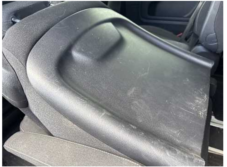
Innenraum (Verschleiß, Kratzer)
